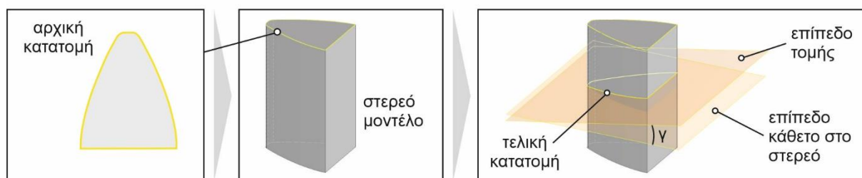
Σχήμα 3.5: Προσδιορισμός κοπτικής κατατομής με βάση τη γωνία αποβλίπτου
