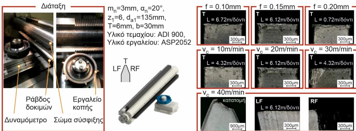
Σχήμα 2.13: Πειραματική διάταξη κατά Kühn et al. Κατανομή φθοράς του κοπτικού εργαλείου για διαφορετικές τιμές πρόωσης και ταχύτητας κοπής
