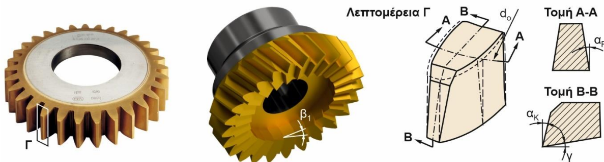
Σχήμα 2.4: Γεωμετρία κοπτικών εργαλείων πλάνισης με κύλιση οδοντώσεων. Κοπτικές γωνίες επί των παρειών του εργαλείου
