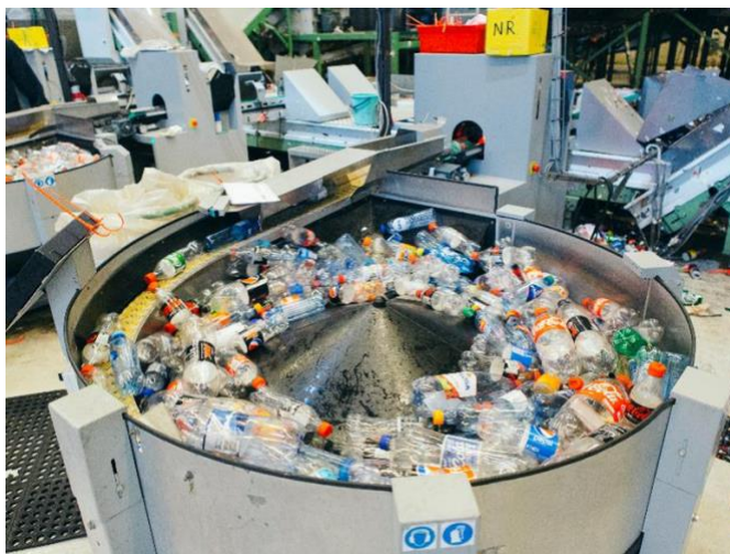
Εικόνα 3.8: Αυτοματοποιημένος εξοπλισμός καταμέτρησης και διαλογής
