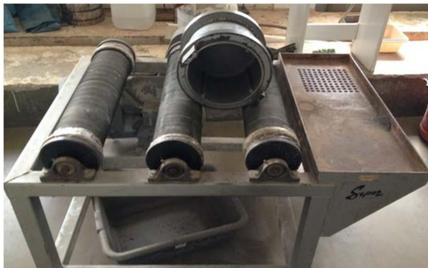
Σχήμα 3.5: Εργαστηριακός Σφαιρόμυλος του Εργαστηρίου Εμπλουτισμού.
