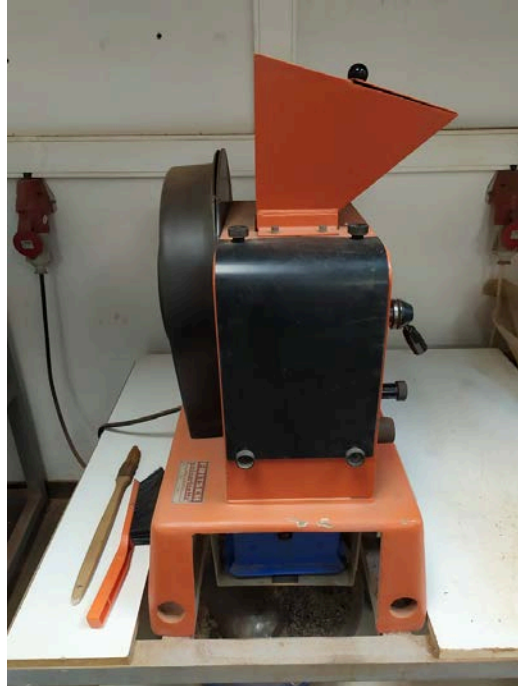
Σχήμα 3.1: Ο σιαγονωτός σπαστήρας του Εργαστηρίου Εμπλουτισμού.
