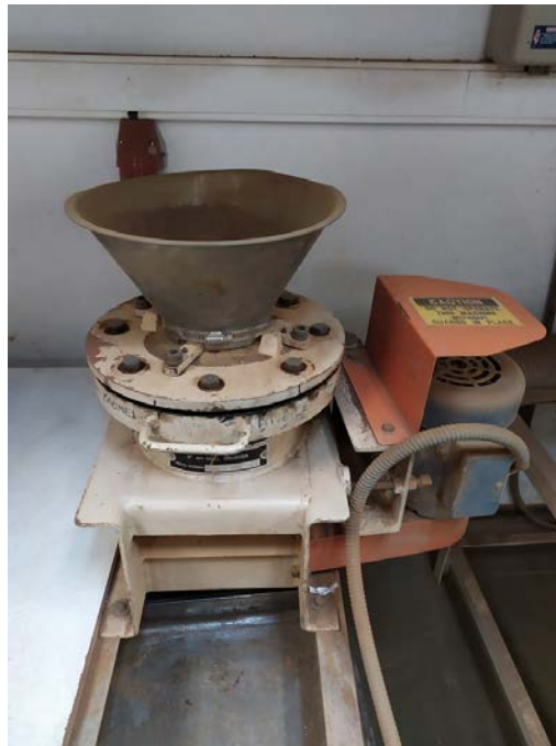
Σχήμα 3.2: Ο κωνικός σπαστήρας του Εργαστηρίου Εμπλουτισμού.
