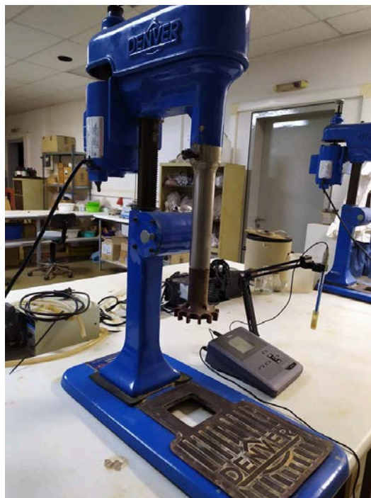
Σχήμα 3.6: Μηχανή επίπλευσης τύπου Denver του εργαστηρίου.
