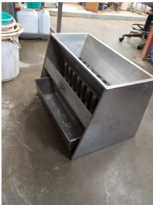
Σχήμα 3.3: Ο δειγματολήπτης Jones του Εργαστηρίου Εμπλουτισμού.
