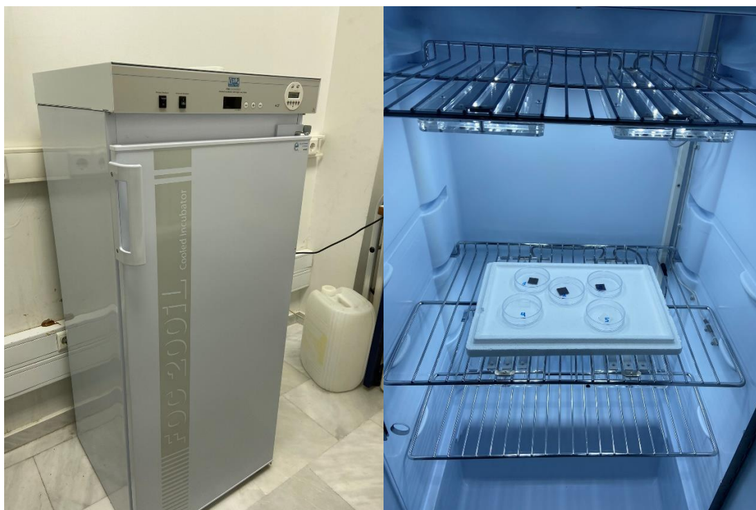
Εικόνα 34: Τοποθέτηση των δειγμάτων στο θάλαμο παλαίωσης
