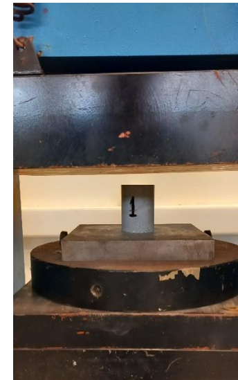
Εικόνα 7.1. Πειραματική διάταξη δοκιμής μονοαξονικής θλίψης (Geotech,2023)
