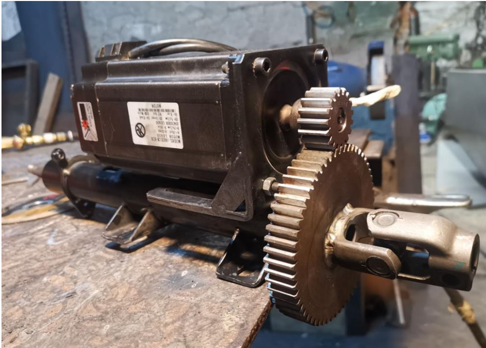
Εικόνα 2821 Κινητήρας-Γρανάζια-Κολώνα
