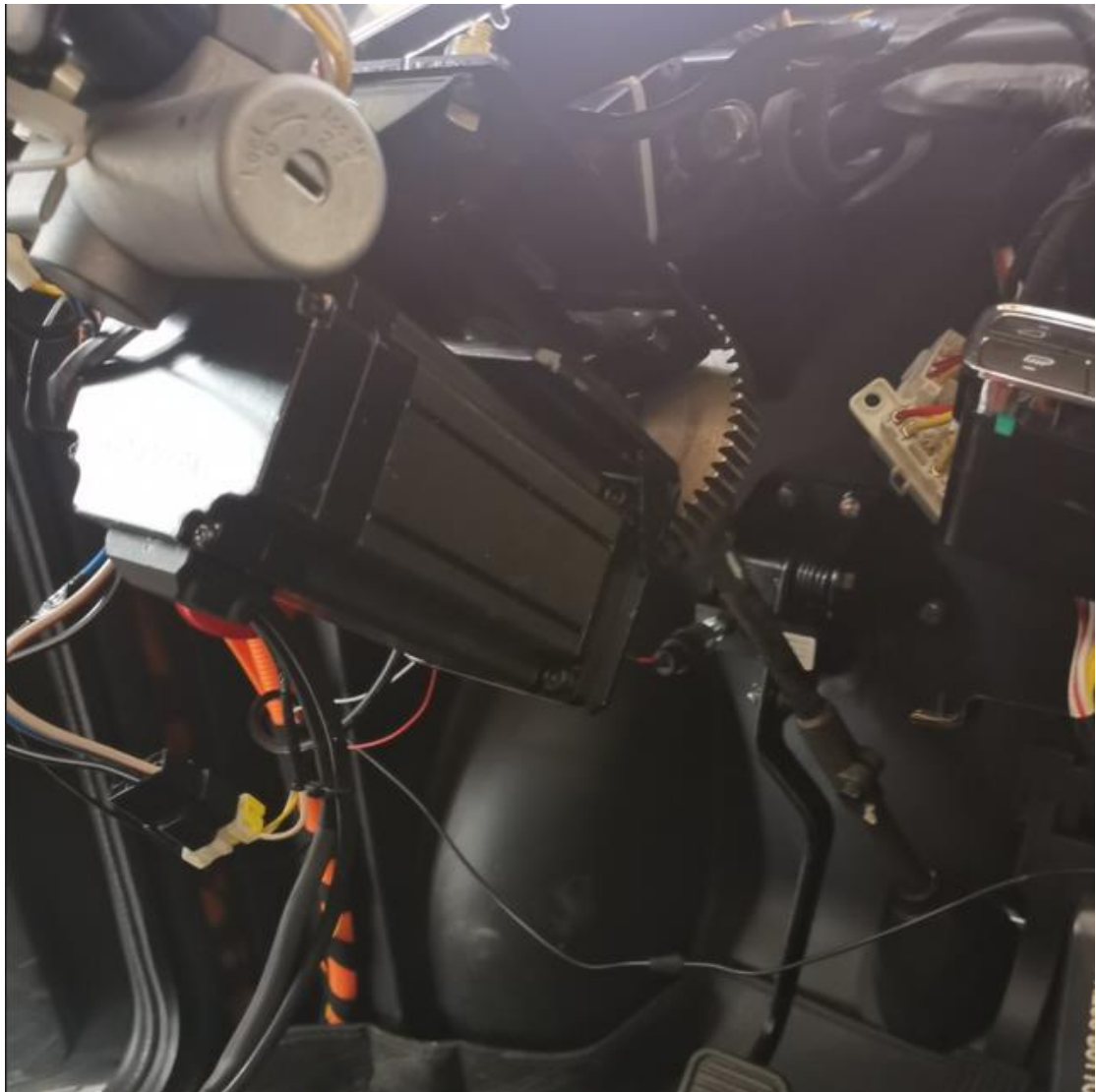
Εικόνα 220 Τοποθέτηση κινητήρα στο Ecocar
