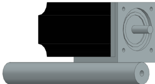
Εικόνα 207 Βάση κινητήρα με τον κινητήρα
