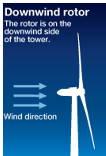
Σχήμα 2.9 Ανεμογεννήτρια με τον δρομέα τοποθετημένο προς την κατεύθυνση αντίθετη του ανέμου
