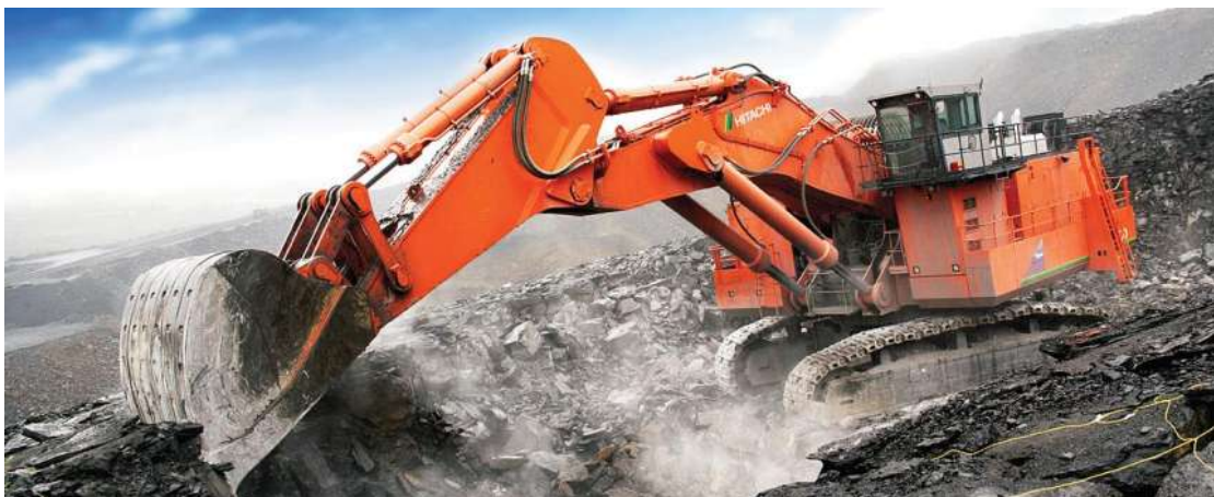
Εικόνα 4.10 Εκσκαφέας ανεστραμμένου κάδου (τσάπα) σε εργασίες φόρτωσης (Πηγή: latomeio.gr )
