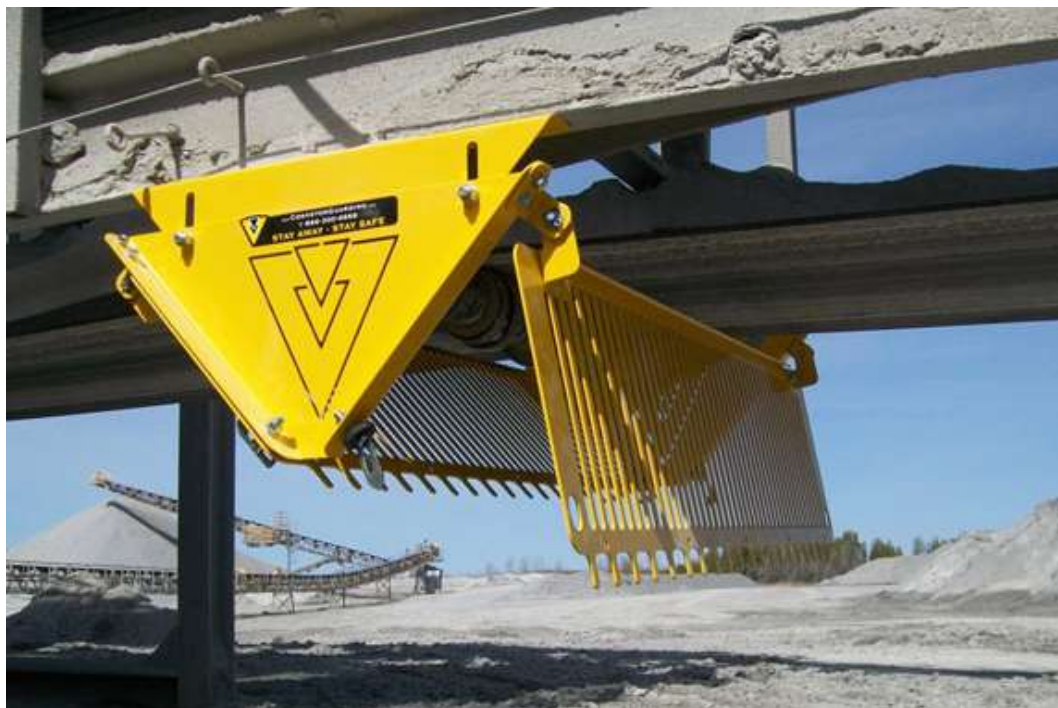
Εικόνα 5.4 Προστατευτικό κάλυμμα κυλίνδρου. (Πηγή M.S.H.A)
