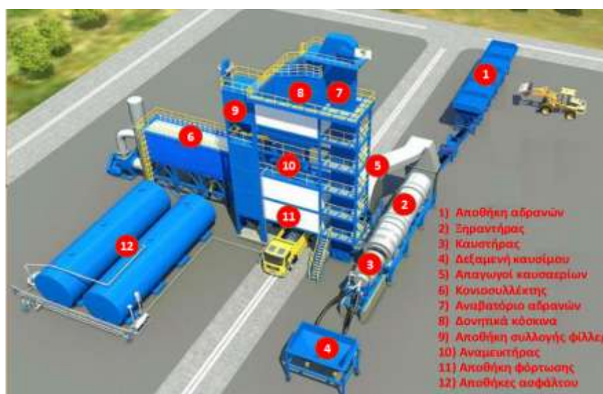
Εικόνα 4.18 Τα μέρη ενός ασφαλτικού συγκροτήματος. (Χασιακός, 2022)
