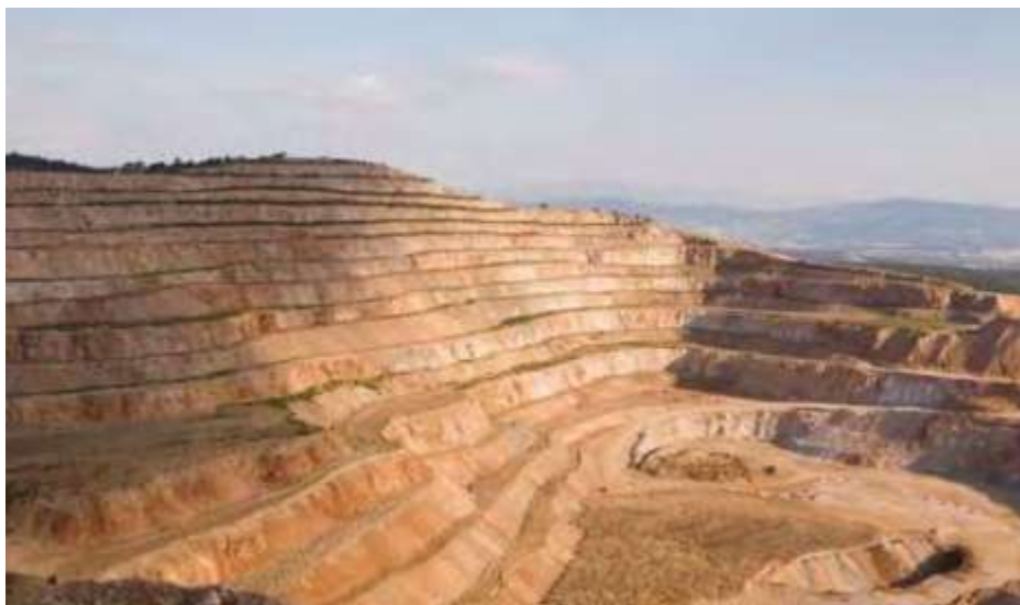
Εικόνα 4.3 Χαρακτηριστική εικόνα εκμετάλλευσης λατομείου αδρανών υλικών - Βαθμίδες λατομείου αδρανών υλικών Χάλυψ Δομικά Υλικά Α.Ε. (πηγή: www.orykta.gr )
