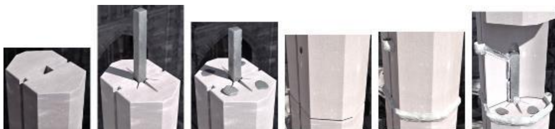
εικόνα 84 στιγμιότυπα από το ντοκιμαντέρ για τον καθεδρικό του Στρασβούργου, από τα αριστερά στα δεξιά διαδοχικά στάδια μεθόδου ενίσχυσης των στύλων (What Makes Strasbourg Cathedral An Architectural Masterpiece? [4K] / Extreme Constructions / Spark, 2019)
