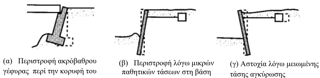
Εικόνα 1.6 : Μηχανισμοί αστοχίας αγκυρωμένων τοίχων (Kramer, 1996).
