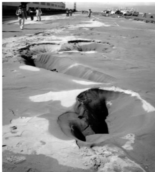
Εικόνα 2.4 : Τχνη ρευστοποίησης, Λιμάνι Hakodate, Ιαπωνία 1993 (PIANC, 2001).
