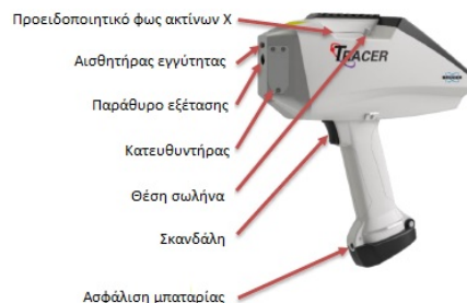
Σχήμα 4.6: Τμήματα του Tracer 5i (αναδιαμόρφωση από Bruker, 2016).
