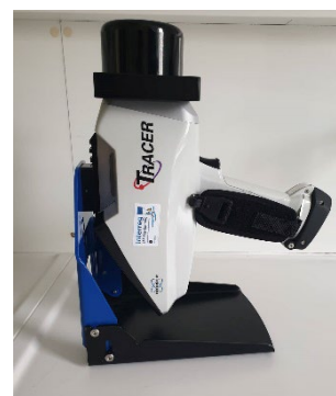
Σχήμα 4.5: Φωτογραφία του Tracer 5i της Bruker σε ειδική βάση.
