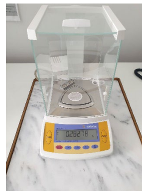
Σχήμα 5.3: Ζυγός ακριβείας Sartorius με φίλτρο προερχόμενο από δειγματοληψία με το DPA14
