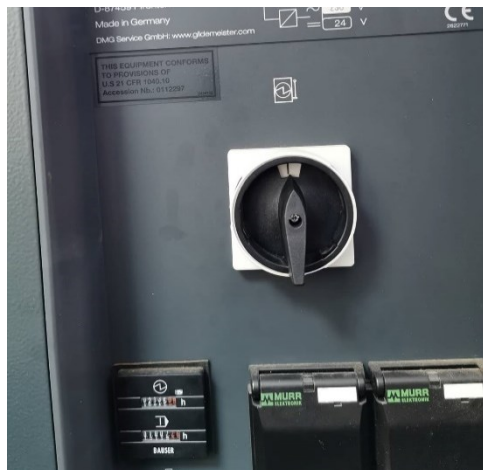
Σχήμα 3.2 : Κεντρικός διακόπτης
