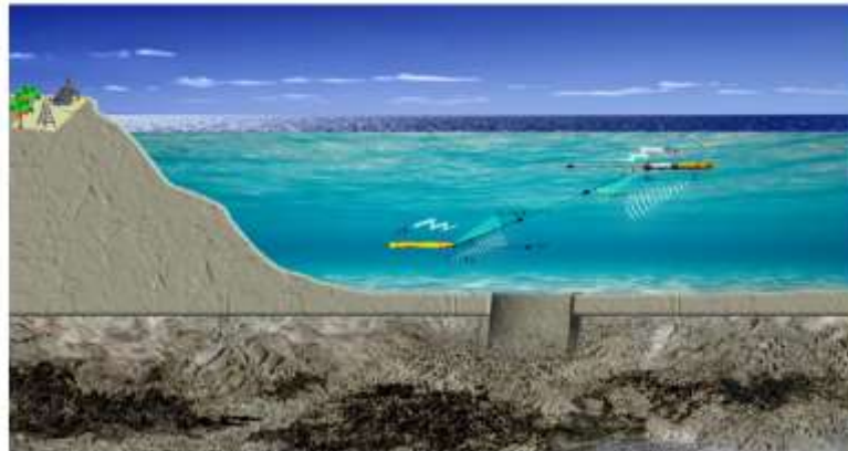
Σχήμα 4.3 : Προκύπτουσα γεωμετρία κατά την ταυτόχρονη κίνηση πομπού και δέκτη εντός του μέσου διάδοσης [3]
