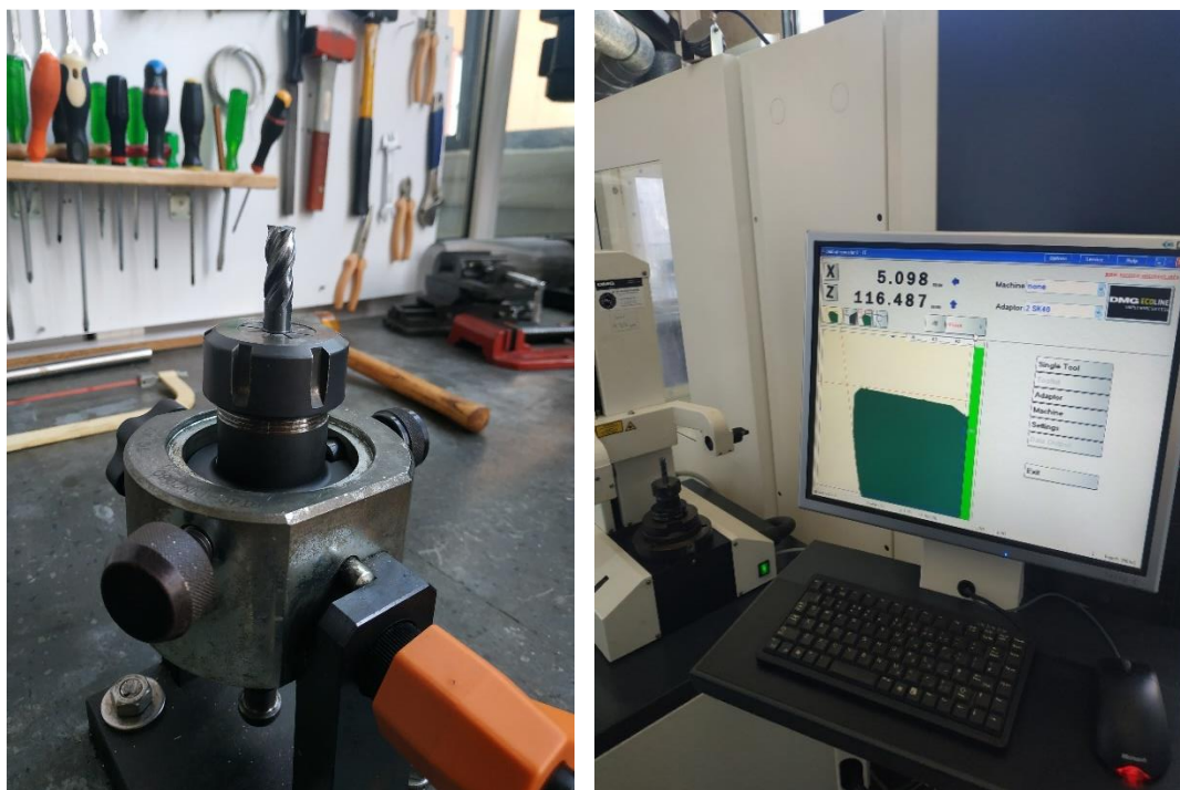
Σχήμα 4.4: Δέσιμο και μέτρηση κοπτικού εργαλείου
