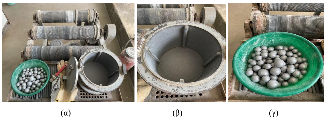
Σχήμα 3.1: Φωτογραφίες (α) μηχανήματος λειοτρίβησης UA Pulveriser, (β) κενού σφαιρόμυλου και (γ) σφαιρών διαφόρων διαμέτρων.
