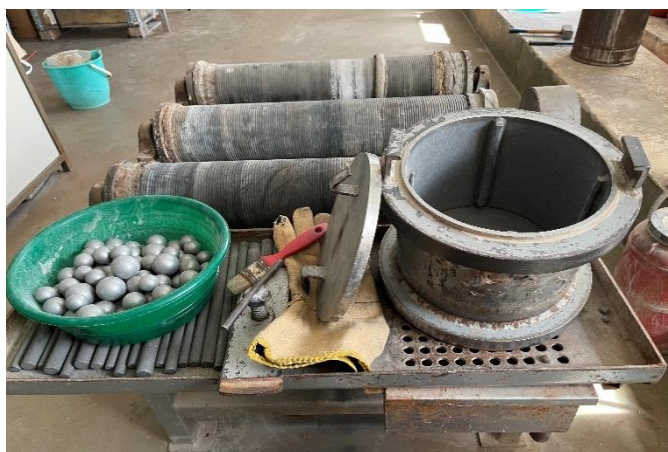
Σχήμα 2.2 : Σφαιρόμυλος τύπου UA Pulveriser
