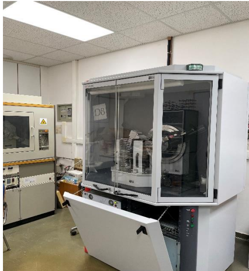
Σχήμα 3.2 : Μονάδα περιθλασίμετρου τύπου D-8, του οίκου Bruker
