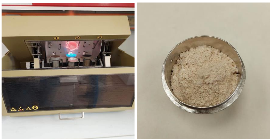
Σχήμα 3.5 : (α) Διαδικασία δημιουργίας ύαλου, (β) Υποδοχέας δείγματος.
