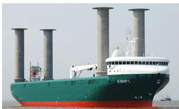
Εικόνα 64. Πλοίο με σύστημα στροφείων Flettner
