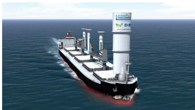
Εικόνα 70. Συνδυασμός ρότορα και ιστίων
