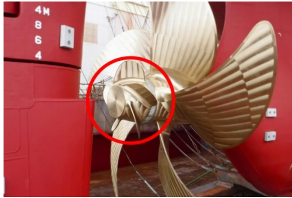
Εικόνα 59. Προπέλα Boss Cap Fins (PBCF) (MFAME, 2017)
