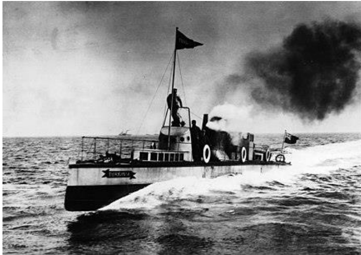
Εικόνα 29. Το πλοίο «Turbinia» με ατμοστρόβιλο
