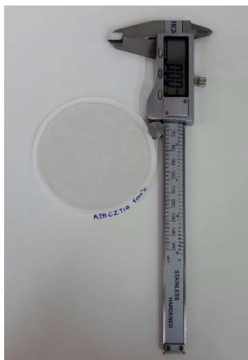
Εικόνα 4.8: Υμένιο « filter cake » (πηγή: φωτογραφία διπλωματικής)
