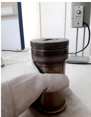
Εικόνα 4.4: Κελί ωρίμανσης με θερμικά επεξεργασμένο πολφό.
