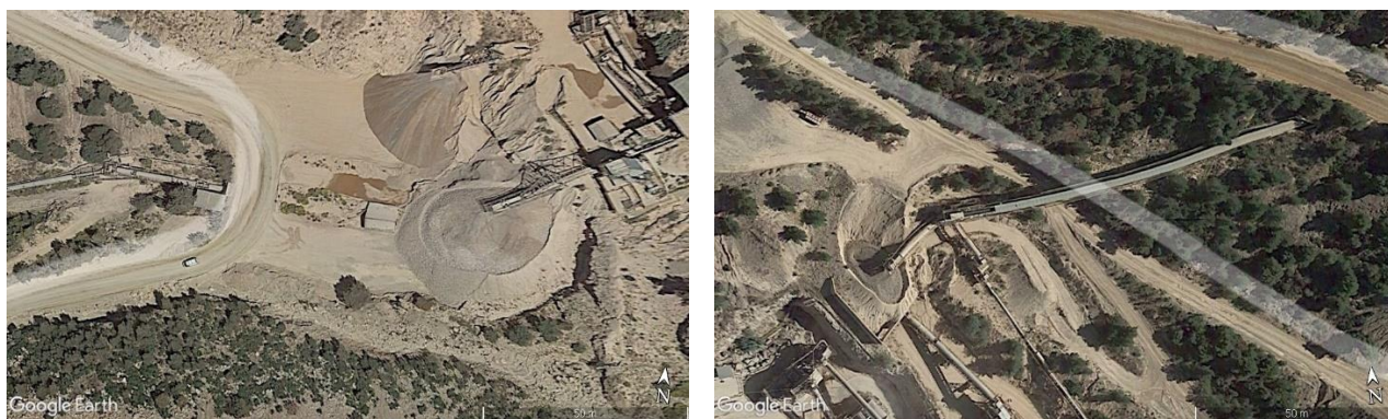
Εικόνα 4.2: Αριστερά: Αεροφωτογραφία των εγκαταστάσεων του λατομείου Ξηρορέματος, όπου φαίνεται η θέση φόρτωσης του υλικού από τους σωρούς στον ταινιόδρομο ΤΔ6. Δεξιά: Θέση απόθεσης του υλικού από τον ταινιόδρομο ΤΔ6 σε σωρούς.
