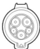
Εικόνα 6-3 Η υποδοχή τύπου 1 χρησιμοποιείται με σταθμό φόρτισης AC .( https://www.arrow.com/en/research-and-events/articles/regulations-and-certification-for-electric-vehicles )
