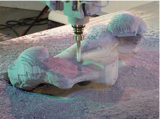
23. CNC, μηχανή που λειτουργεί μέσω ηλεκτρονικού υπολογιστή.
