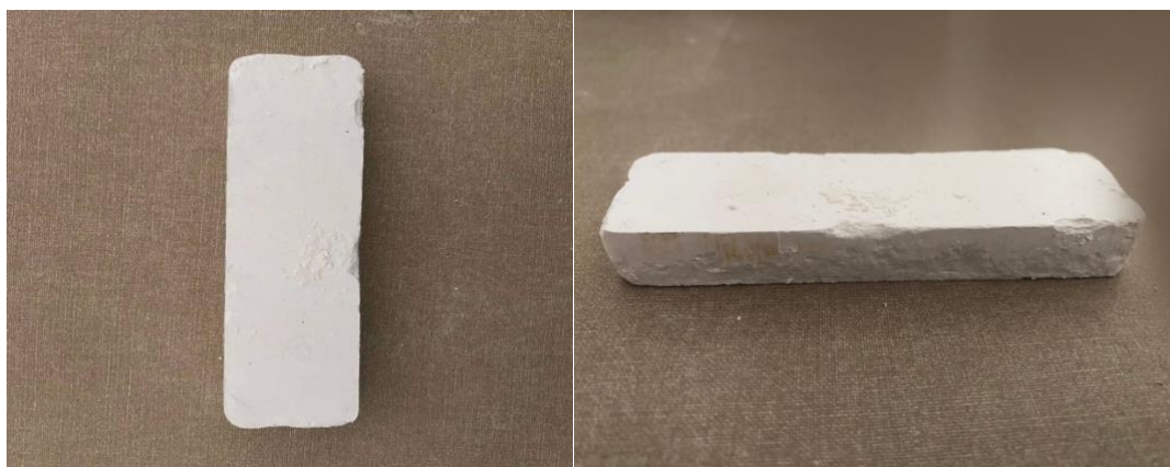
Σχήμα 12: Παραχθέν δοκίμιο με χρήση καλουπιού από σχήμα 10. Αποτελείται από 40 g καολίνη, 4 g \text{CaCO}_3 και 5 ml \text{H}_2\text{O} ., Διαστάσεις: X * Y * Z = 100 \text{ mm} * 26 \text{ mm} * 10 \text{ mm} , βάρος: W = 44 \text{ g}
