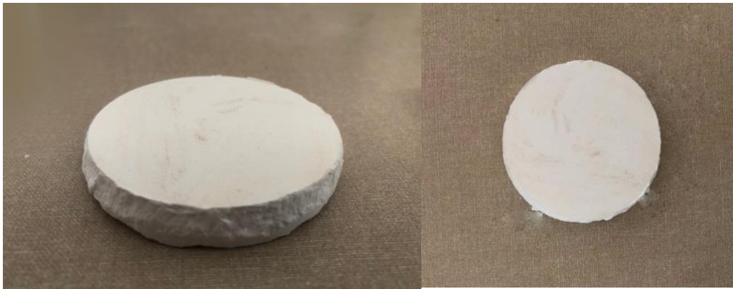
Σχήμα 13: Παραχθέν δοκίμιο με χρήση καλουπιού από σχήμα 11. Αποτελείται από 30g καολίνη, 3 g \text{CaCO}_3 και 5 ml \text{H}_2\text{O} . Διαστάσεις: X * Y = 58 \text{ mm} * 6 \text{ mm} , βάρος: W = 26,6 \text{ g}
