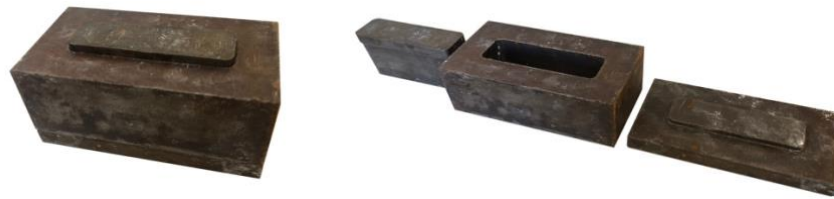
Σχήμα 10 Καλούπι ορθογώνιας διατομής
