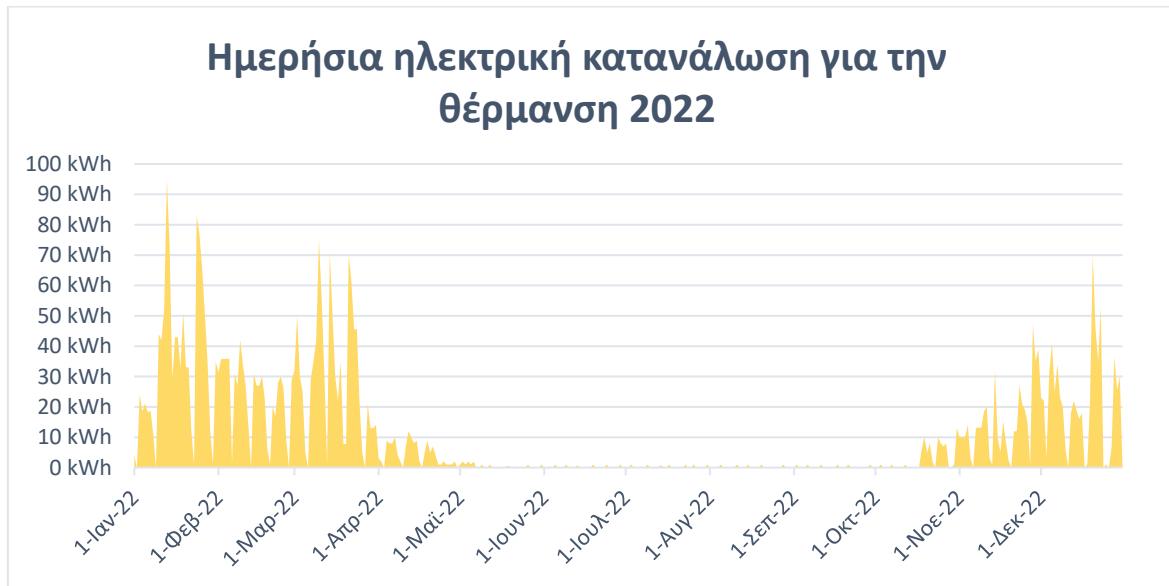
Εικόνα 49 Διάγραμμα ημερήσιας ηλεκτρικής κατανάλωσης για τη θέρμανση όπως μετρήθηκε από το αισθητήριο της αντλίας για το έτος 2022
