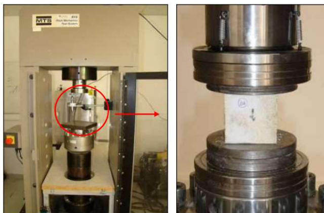
Σχήμα 3.2: Δοκιμή μονοαξονικής θλίψης με μηχανή MTS.
