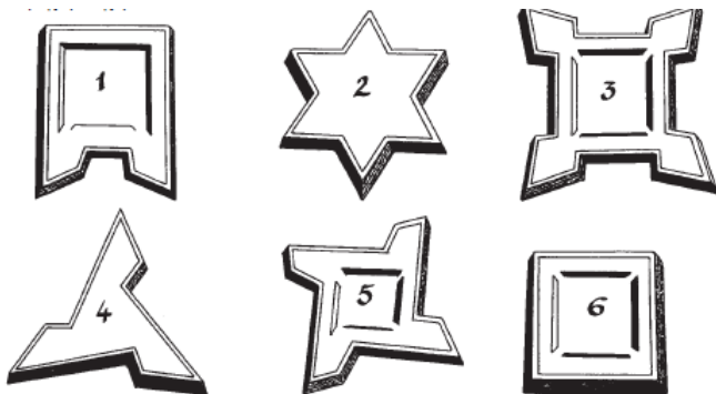
Εικόνα 16: Τυπολογίες προμαχωνικών οχυρωματικών έργων συμπληρωματικής άμυνας
