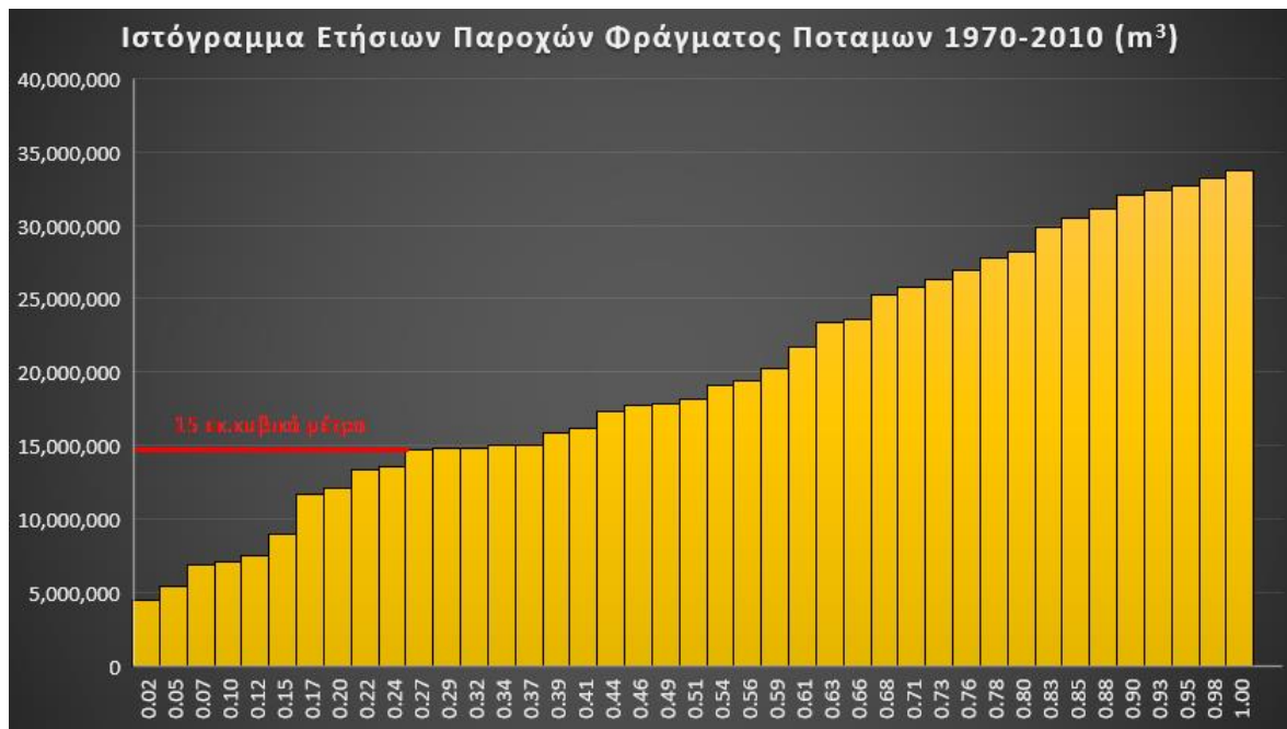
Ιστόγραμμα 1: Ποσοστό αστοχίας κάλυψης των 15 εκ. κυβικών μέτρων νερού για το Φράγμα Ποταμών..
