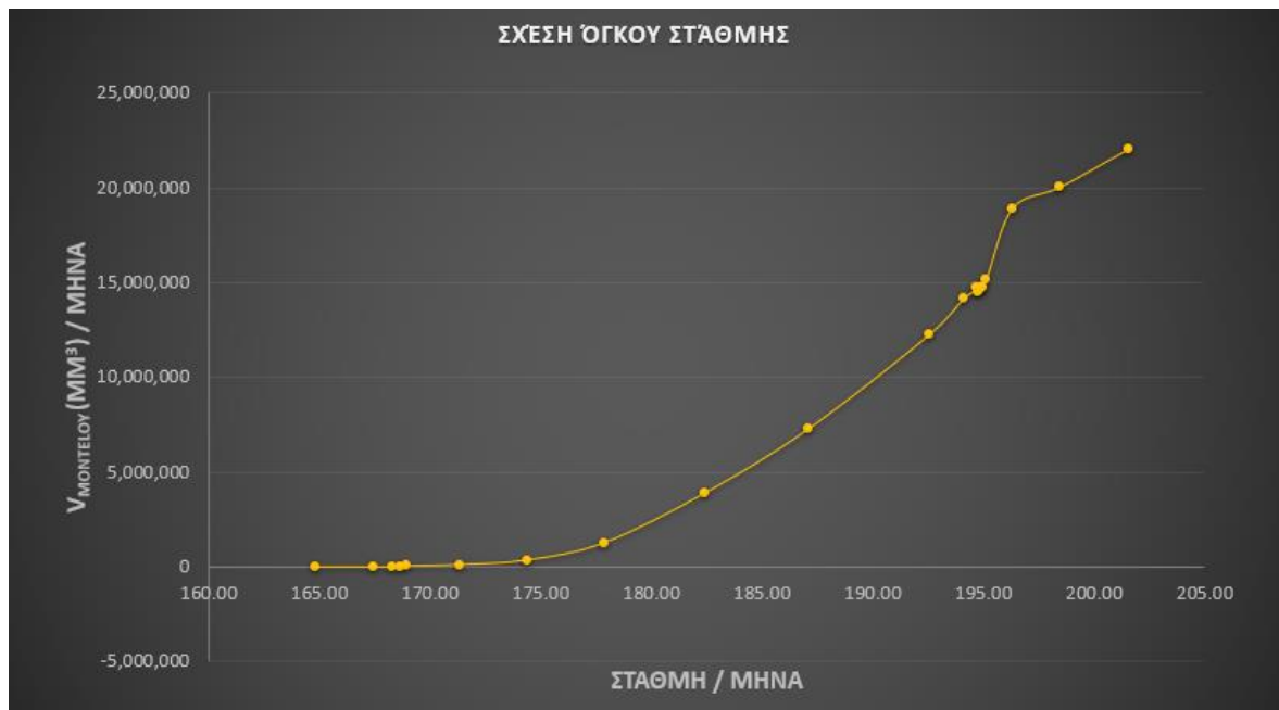
Διάγραμμα 21: Σχέση όγκου και στάθμης του ταμιευτήρα του μοντέλου.
