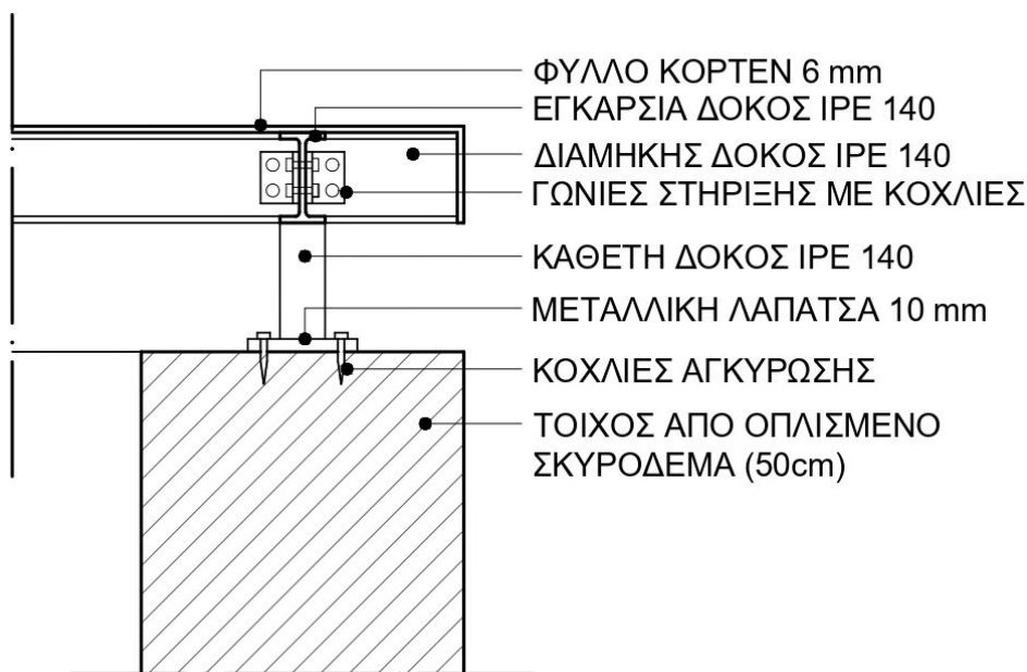
Λεπτομέρεια στήριξης μεταλλικού στεγάστρου
