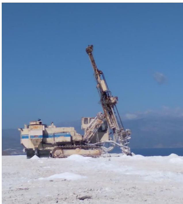
Εικόνα 1.4: Διατρητικό φορείο της Furukawa (Top Hammer) από το λατομείο στη θέση Αλτσί, Κρήτης.
