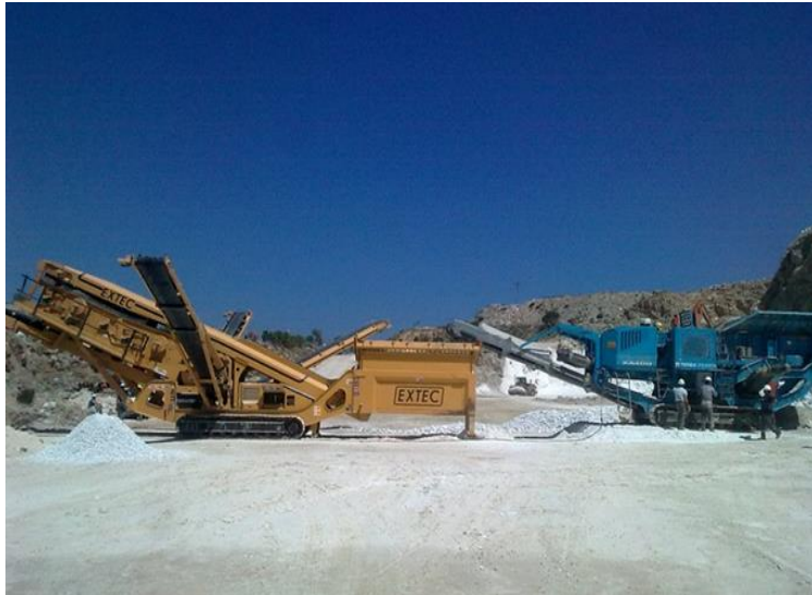
Εικόνα 1.8: Κινητός σπαστήρας και κινητό κόσκινο από το λατομείο στη θέση Αλτσί, Κρήτης.
