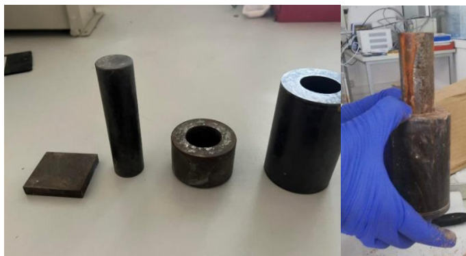
Εικόνα 2.10: α) Καλούπια μορφοποίησης μείγματος και β) εξώθησης.
