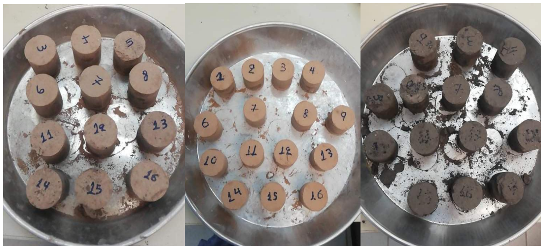
Εικόνα 2.14: α) Δοκίμια απόβλητου τούβλου-κελύφους φυσιτικού μετά την έψηση, β) Δοκίμια απόβλητου τούβλου μετά την έψηση και γ) Δοκίμια απόβλητου τούβλου-κελύφους φυσιτικού (μετά από πυρόλυση).
