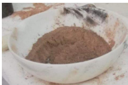
Εικόνα 2.5: Μείγμα από απόβλητο τούβλο και κέλυφος φυστικιού (μετά από πυρόλυση).
