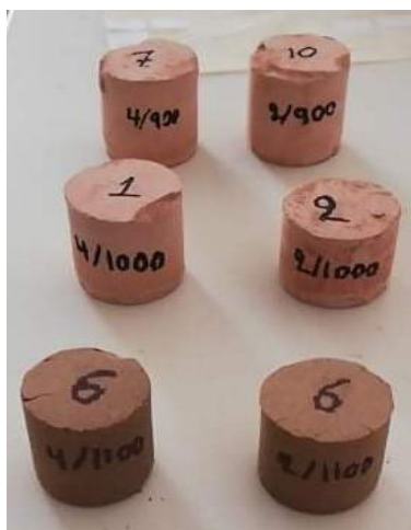
Εικόνα 2.15: Δοκίμια με απόβλητο τούβλο-κέλυφος φυσιτικού-χαλαζιακή άμμο μετά την έψηση.
