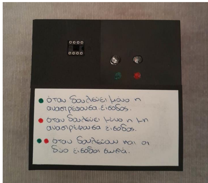
Εικόνα 24: Παρουσίαση του Op-Amp 741 Tester
