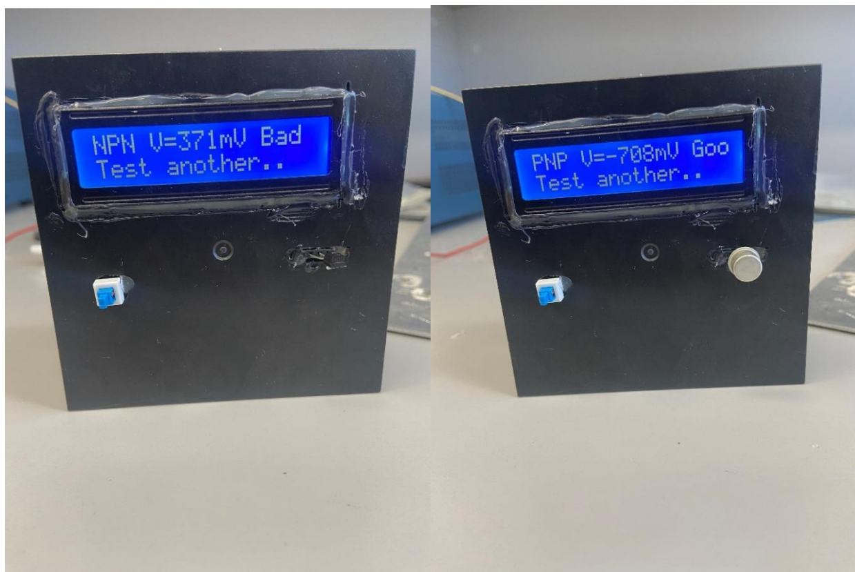
Εικόνα 20: Ενδείξεις λειτουργίας του BJT Tester σε transistor
