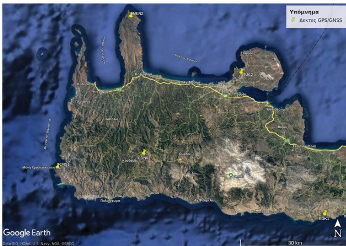
Σχήμα 6.1: Μόνιμοι σταθμοί GPS/GNSS στο νομό Χανίων.
