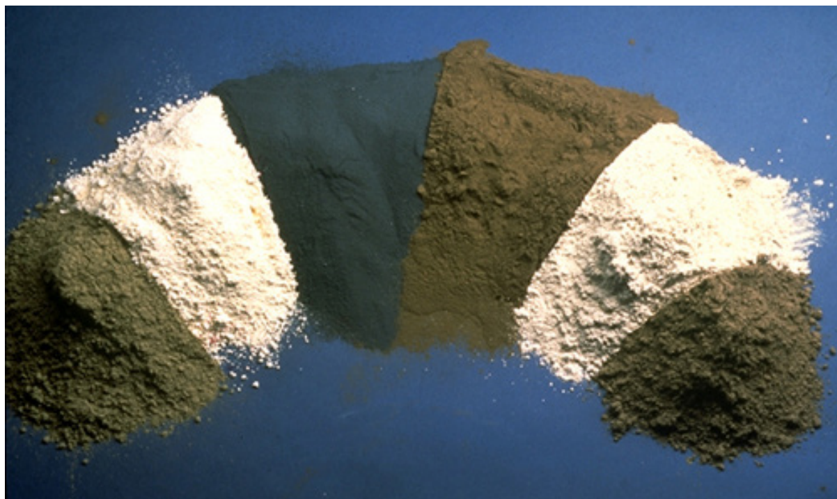
Εικ. 14: Ποζολάνες, από αριστερά προς τα δεξιά Ιπτάμενη τέφρα κατηγορίας C, μετακαολίνης, πυριτική παιπάλη, ιπτάμενη τέφρα κατηγορίας F, σκωρία, θερμικά επεξεργασμένος σχιστόλιθος, (ΝΙΚΟΛΟΠΟΥΛΟΣ Ο., 2019)
