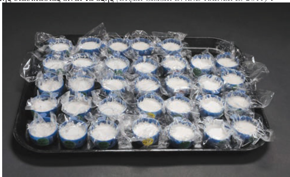
Εικ. 29: Δοκίμια συρρίκνωσης χυτευμένα με χρήση πλαστικού φύλλου, BIÇER-SIMSIR B. AND RAINER L. 2011
