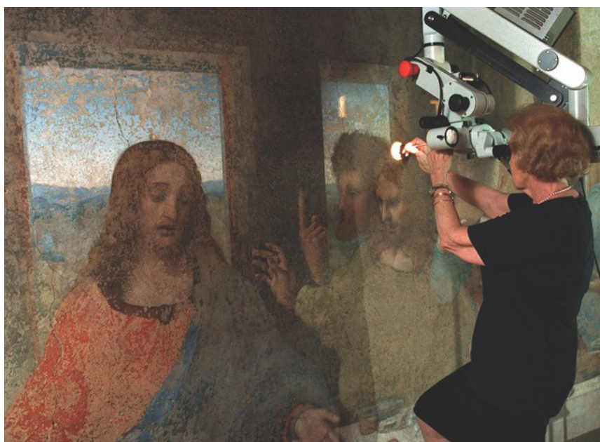
Εικ. 42: Υπέρυθρη ανακλαστογραφία στο Μυστικό Δείπνο, (E&T, 2021)
