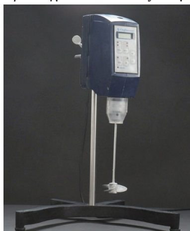
Εικ.20: Αναδευτήρας ενέματος μεταβαλλόμενης ταχύτητας (BIÇER-SIMSIR B. AND RAINER L. 2011)
