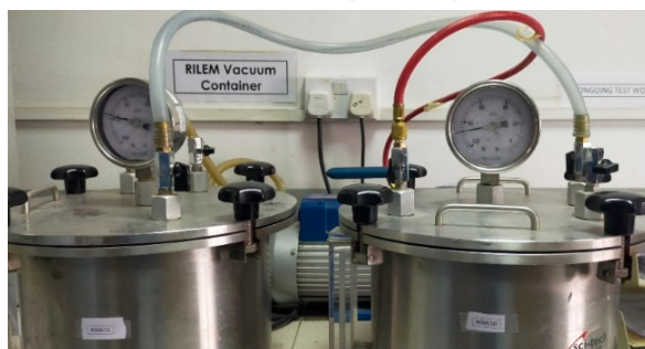
Εικ. 33: Δοκίμιο σε δεξαμενή κενού κατά την αφαίρεση του αέρα, (KEWALRAMANI AND KHARTABIL 2021)
