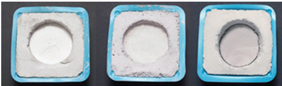
Εικ. 58: Έλεγχος αποτελεσμάτων : Αριστερά δεν συρρικνώθηκε, κέντρο μέτρια συρρικνωση, δεξιά μεγάλη συρρικνωση (BİÇER-SIMSIR B. AND RAINER L. 2011)
