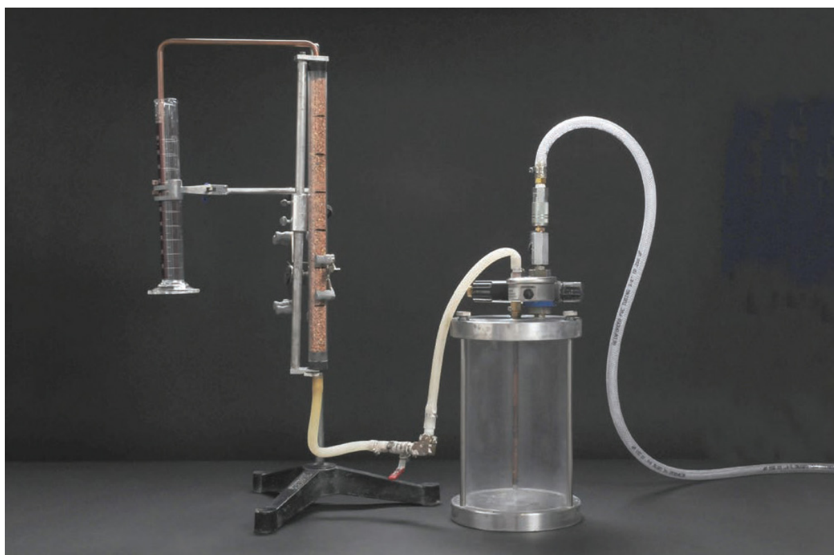
Εικ. 24: Παράδειγμα συσκευής ελέγχου ενεσιμότητας, (BIÇER-SIMSIR B. AND RAINER L. 2011)
