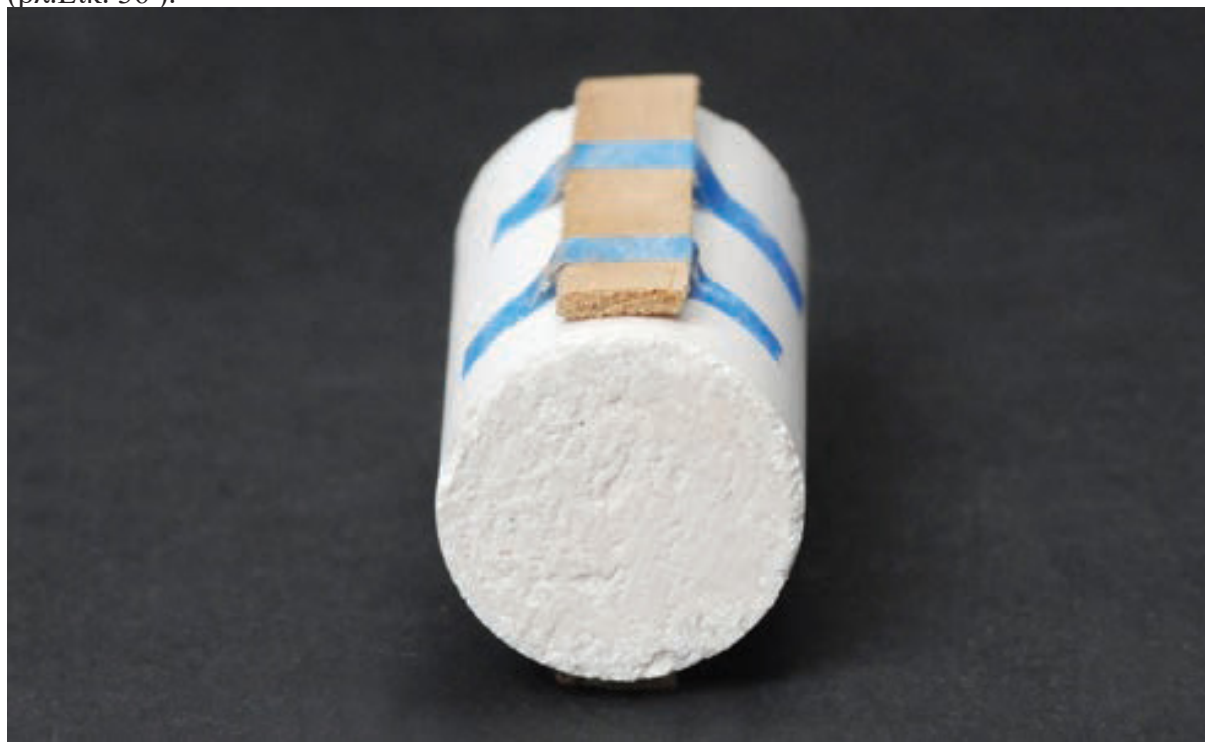
Εικ. 35: Δείγμα ελέγχου με προσαρτημένα ξύλινα φύλλα, (BİÇER-SIMSIR B. AND RAINER L. 2011)
