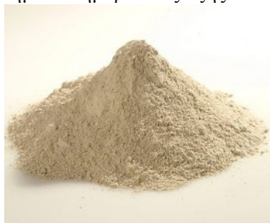
Εικ. 13: Φυσική υδραυλική άσβεστος (NHL 3.5), (EM4C, 2021)
