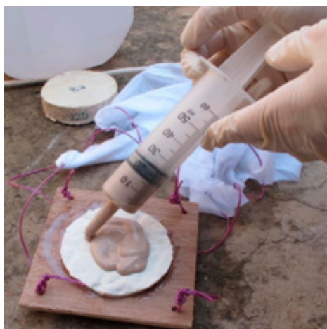
Εικ. 59: Προετοιμασία δοκιμής «Sandwich» για αρμόστοκους MG, ©THE COURTAULD INSTITUTE OF ART, 2016.
