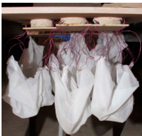
Εικ. 60: Δοκιμή «Sandwich» για αρμόστοκους G, ©THE COURTAULD INSTITUTE OF ART, 2016.
