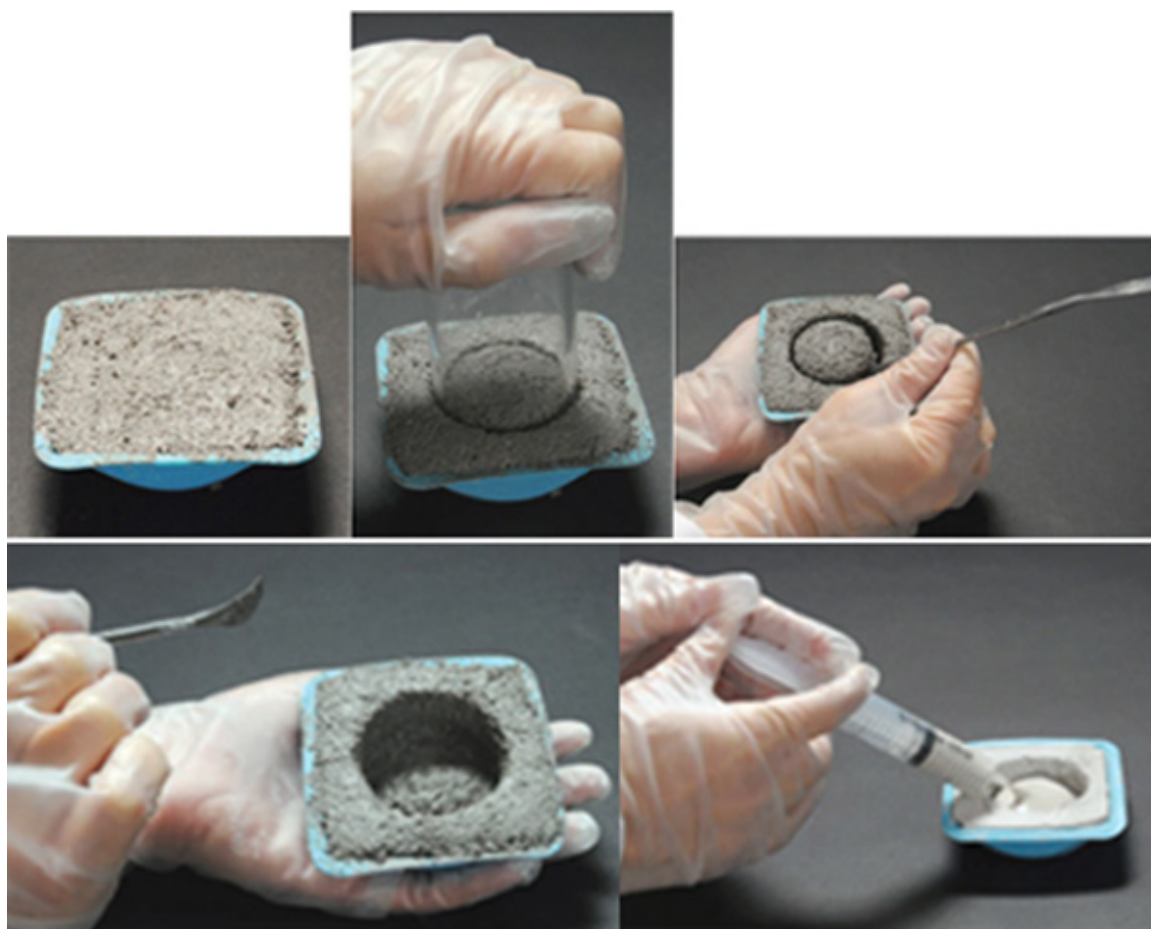
Εικ. 57: Προετοιμασία ελέγχου συρρίκνωσης (BIÇER-SIMSIR B. AND RAINER L. 2011)
