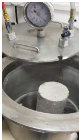
Εικ. 32: Δοκίμιο σε δεξαμενή κενού πριν τον έλεγχο, (KEWALRAMANI AND KHARTABIL 2021)
