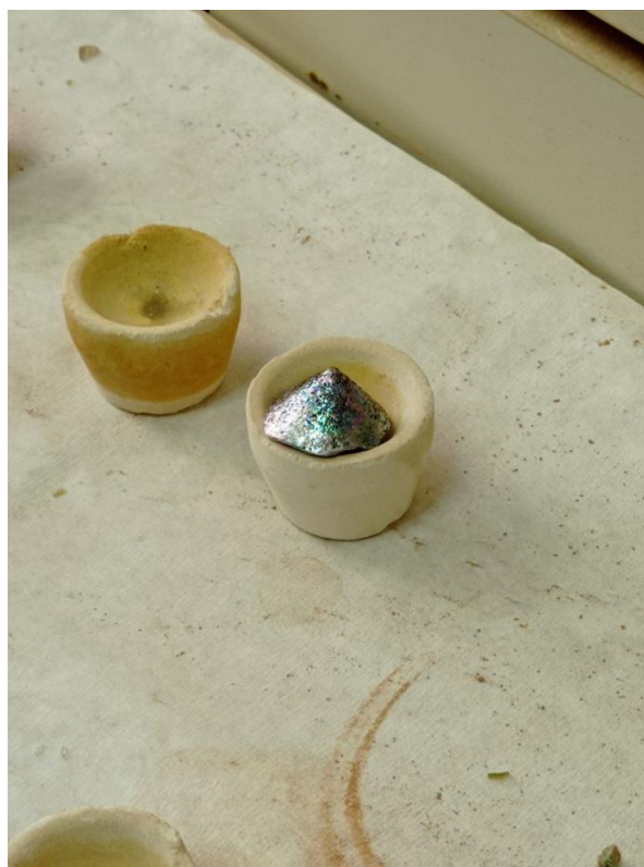
Εικόνα 18: Διαχωρισμός μεταλλικής χελώνας από τη σκωρία
