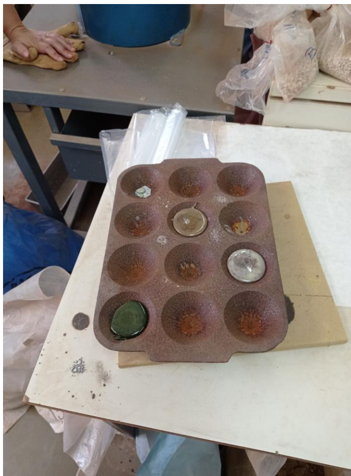
Εικόνα 16: Χύτευση δειγμάτων σε μεταλλικά κωνικά καλούπια
