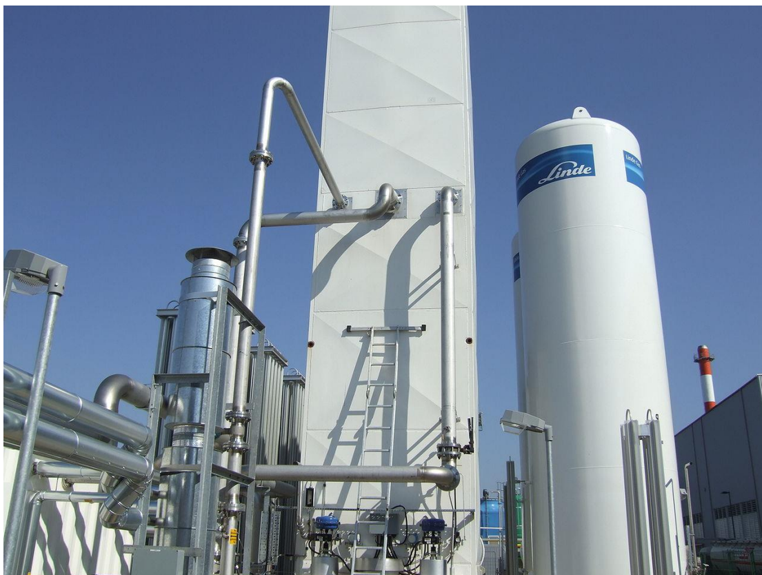
Εικόνα 12: Αποστακτική στήλη σε εγκαταστάσεις διαχωρισμού οξυγόνου μέσω κρυογενικής διεργασίας
