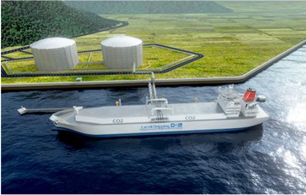
Εικόνα 41: Η Mitsui OSK Lines σε συνεργασία με τα ναυπηγεία Mitsubishi στην Ιαπωνία σχεδίασαν ένα πλοίο αποκλειστικά για την μεταφορά υγροποιημένου διοξειδίου του άνθρακα. (MOL, 2021)
