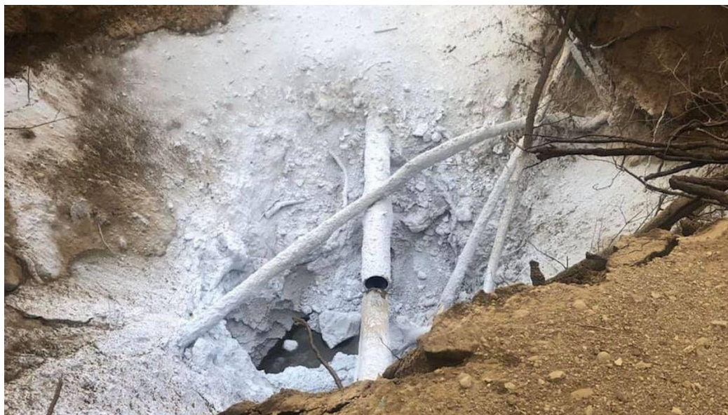
Εικόνα 44: Έκρηξη αγωγού μεταφοράς διοξειδίου στη Σατάρτια στις ΗΠΑ (watch, 2021)
