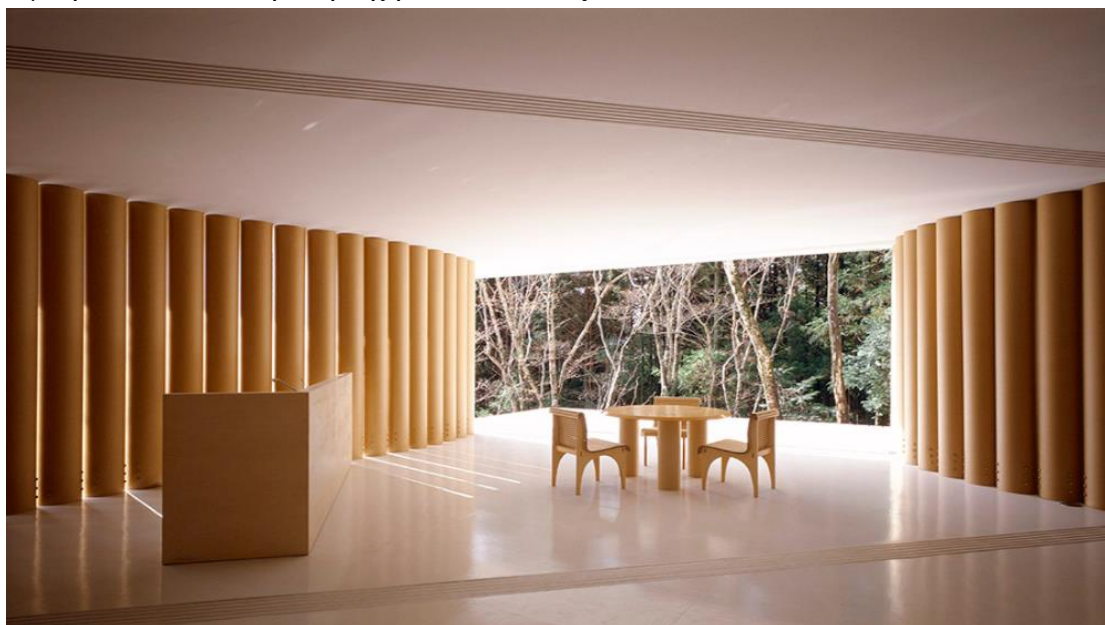
Εικόνα 24 Εσωτερική άποψη, χάρτινα υποστυλώματα
