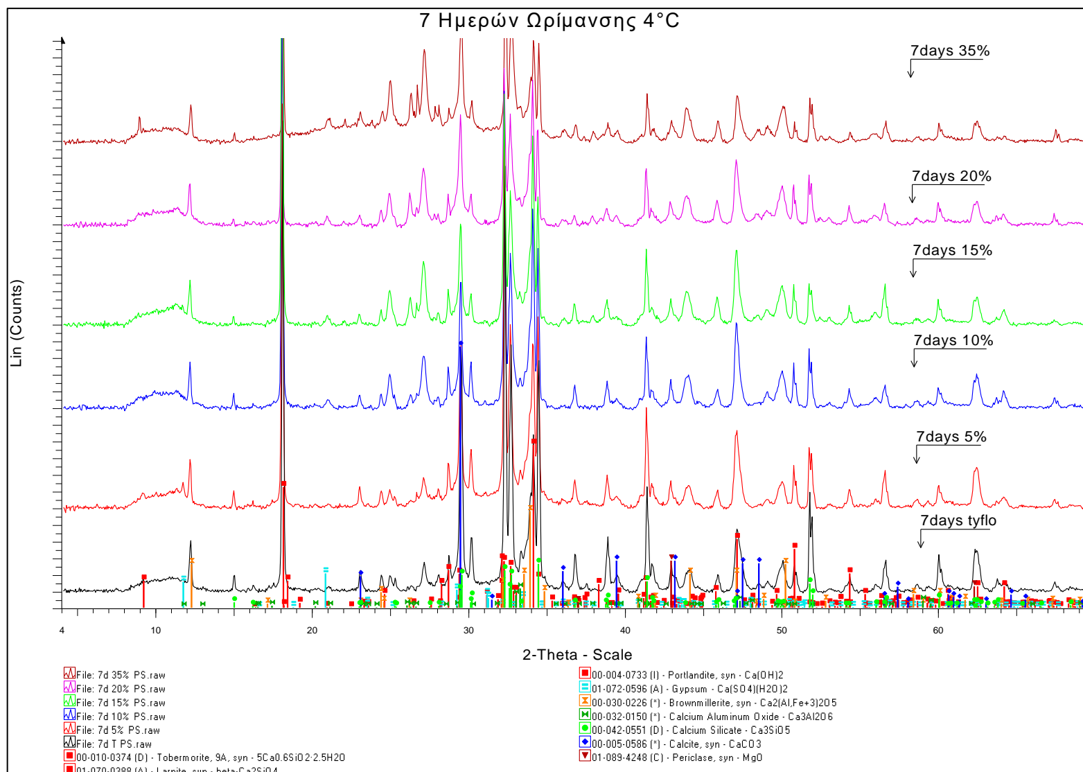
Εικόνα 9: Ακτινογραφήματα περιθλασιμετρίας ακτίνων – X (XRD), 7 ημερών ωρίμανσης στους 4 °C για διαφορετικές περιεκτικότητες αντικατάστασης περλίτη.
