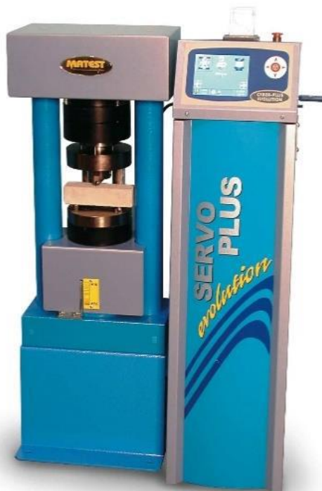
Εικόνα 7: Μηχανή μέτρησης αντοχής σε μονοαξονική θλίψη.
