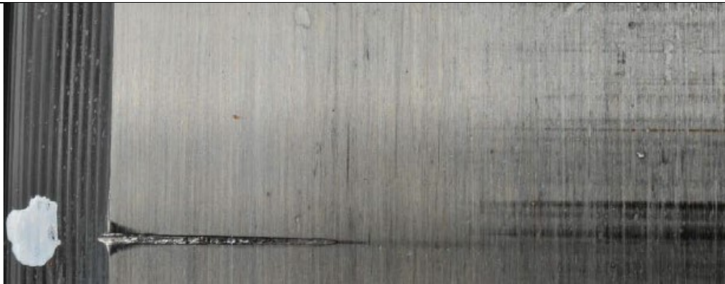
Εικόνα 5.4 Το χτύπημα στο εσωτερικό δαχτυλίδι του τριβέα του πλανητικού μέρους
