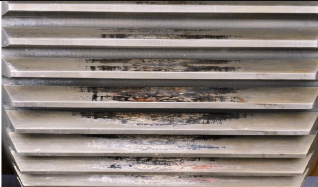
Εικόνα 5.3 Κατανομή φθοράς στο μέσο του γραναζιού με πιο έντονη στη φορά περιστροφής. Περίπου το 50% του οδόντα μετέφερε το φορτίο
