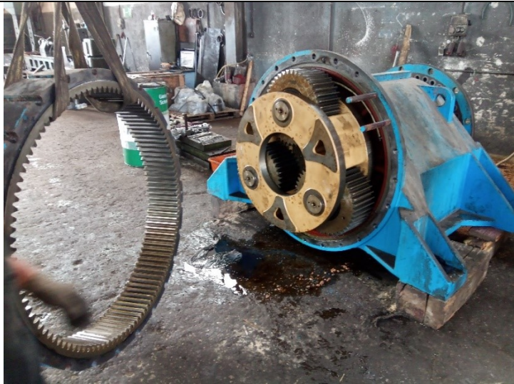
Εικόνα 5.1 Κατά τη διάρκεια εξάρμωσης του γραναζοκιβωτίου
