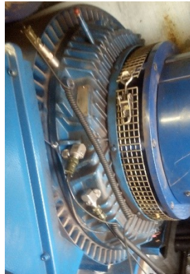
Εικόνα 3.23 Σημεία τοποθέτησης των αισθητήρων
