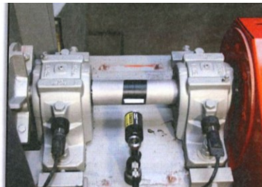
Εικόνα 2.3 Στροφόμετρο συνδεδεμένο με τον data collector
