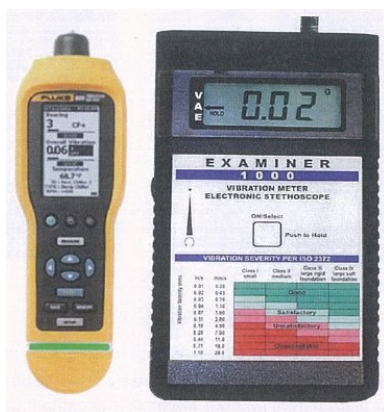
Εικόνα 2.6 Φορητή συσκευή μέτρησης ταλαντώσεων
