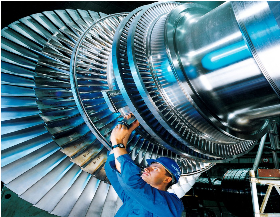
Εικόνα 2.12 Ρότορας ενός σύγχρονου ατμοστροβίλου [16]
