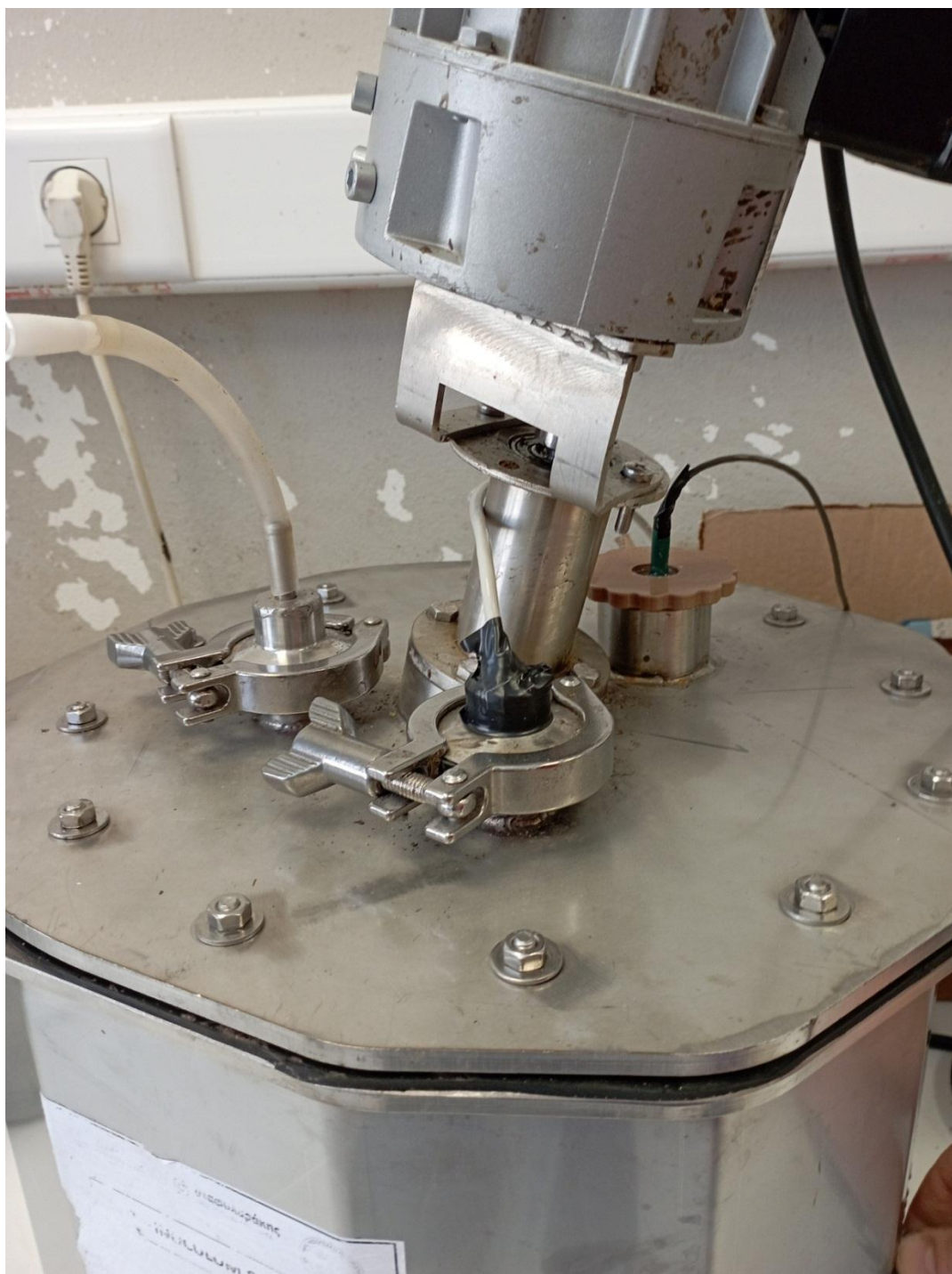
Εικόνα 38: Τοποθέτηση των αισθητήρων στο βιοαντιδραστήρα
