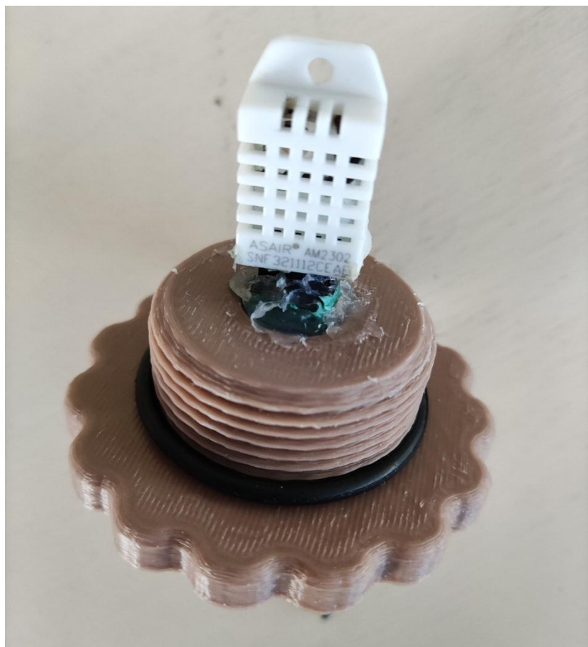
Εικόνα 23: Προσαρμογέας εκτυπωμένος σε 3D printer για την ασφαλή τοποθέτηση του αισθητήρα υγρασίας μέσα στο βιοαντιδραστήρα
