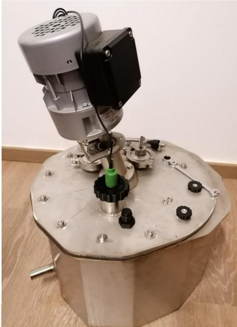
Εικόνα 14: Διάταξη του βιοαντιδραστήρα διαλείποντος έργου που χρησιμοποιήθηκε στην παρούσα εργασία
