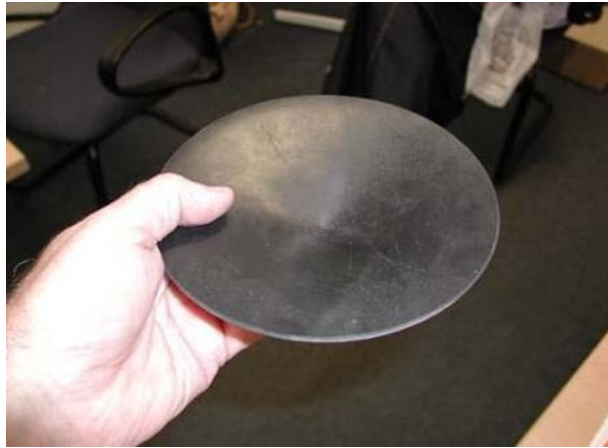
Εικόνα 3- 4: Μικρό ταψί συγκέντρωσης σχήματος κώνου και επενδυμένο με καουτσούκ για δοκιμές μεταλλεύματος (Περού) (Veiga M. , 2006)
