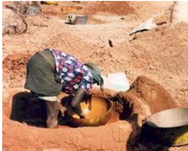
Εικόνα 3- 5: Χρησιμοποιώντας αντικείμενα κατασκευασμένα από το σκληρό κέλυφος ενός φρούτου στην Αφρική ως ταψιά συγκέντρωσης (calabash or calabace) (Veiga M. , 2006)
