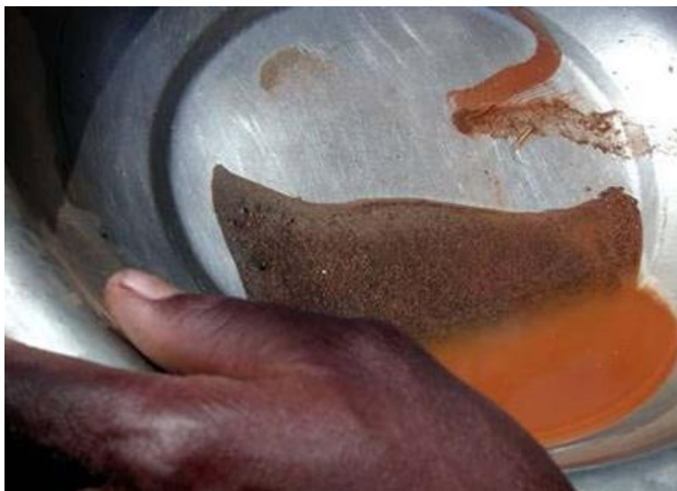
Εικόνα 3-2: Αλουμινένιο μπολ που χρησιμοποιείται ως ταψί συγκέντρωσης (Σουδάν) (Veiga M. , 2006)
