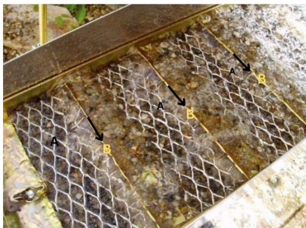
Εικόνα 3- 8:Μεταλλική εσχάρα (σημείο A) και βασικές ραβδώσεις υδροσυγκεντρωτή (σημείο B) (Weishaupt & Jacobson, 1989)
