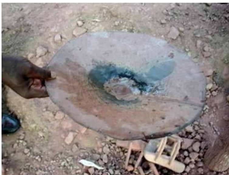
Εικόνα 3- 3:Μεταλλικό ταψί συγκέντρωσης «batea» (Βραζιλία) (Veiga M. , 2006)
