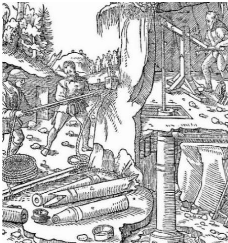
Εικόνα 1- 6: Σχηματική απεικόνιση της αρχής λειτουργίας της εμβολοφόρου αντλίας της εποχής (Agricola, 1950)
