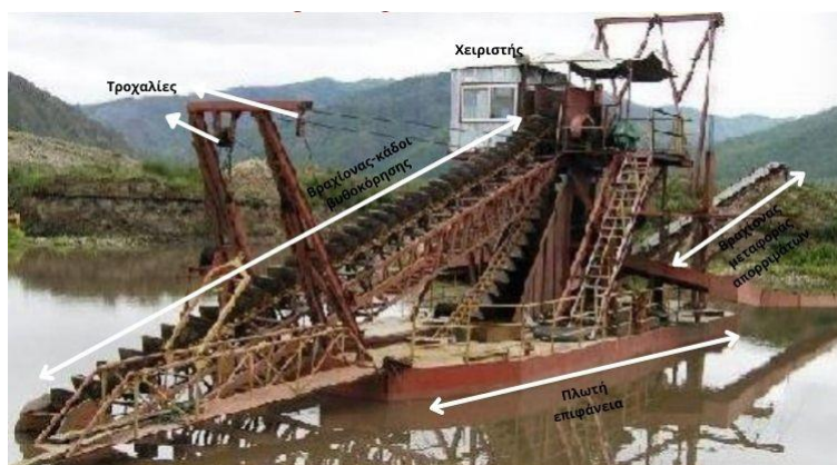
Εικόνα 3- 12: Πλωτή βυθοκόρηση γραμμής κάδων (Μεσαίου μεγέθους) (Grayson, 2008)
