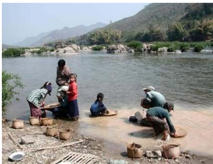
Εικόνα 3- 1:Ξύλινα ρηχά ταψιά συγκέντρωσης «bateas» (Lao, PDR) (Veiga M. , 2006)
