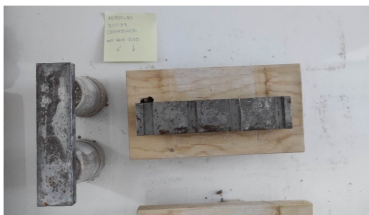
Εικόνα 99: Τοποθέτηση βαριδίων στα δοκίμια κατά την ξήρανσή τους
