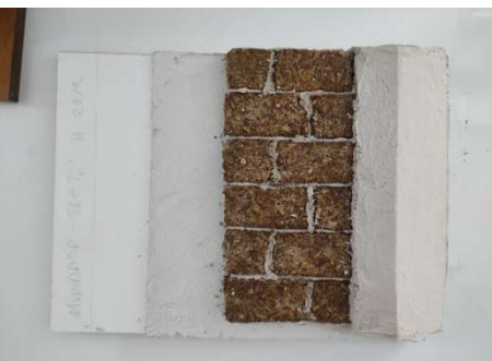
Εικόνα 122: Τοποθέτηση τελικής στρώσης επιχρίσματος
