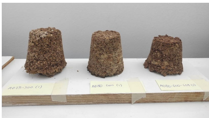
Εικόνα 79: Δοκίμια μετά την τοποθέτησή τους στο εξωτερικό περιβάλλον
