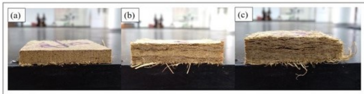
Εικόνα 37: Δοκιμή δειγμάτων στην απορρόφηση νερού( https://www.mdpi.com )
