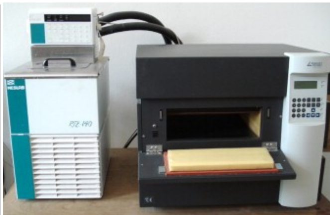
Εικόνα 13: Μηχάνημα μέτρησης θερμικής αγωγιμότητας ( https://www.sciencedirect.com/ )
