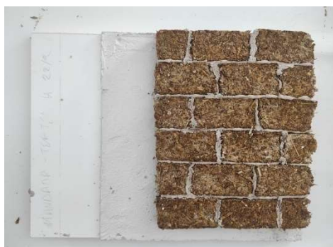
Εικόνα 119: Τοποθέτηση των μπλόκ πάνω στον τοίχο μετά το αρμολόγημα
