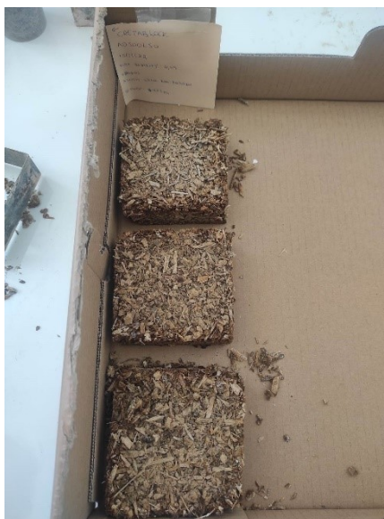
Εικόνα 106: Εμφάνιση εύθραυστων γωνιών και δυσκολία στην μεταφορά
