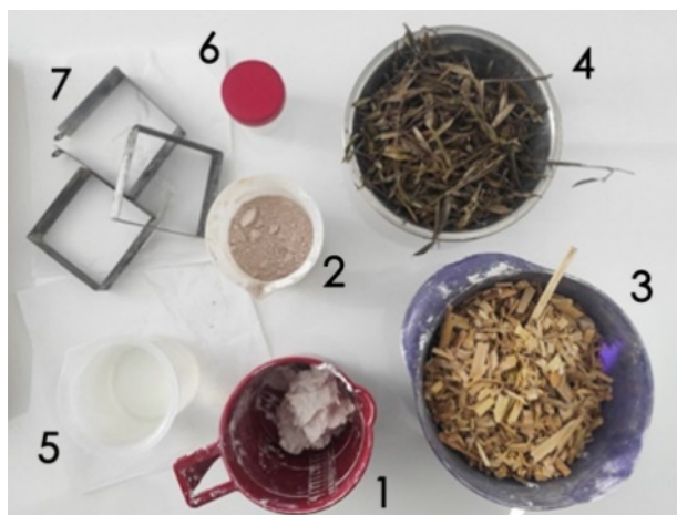
Εικόνα 81: 1.ασβεστοπολτός 2.ποζολάνη 3.καλάμι 4.φύλλα ελιάς 5.νερό 6.καλούπι ποτηράκι 7.καλούπι τετράγωνο
