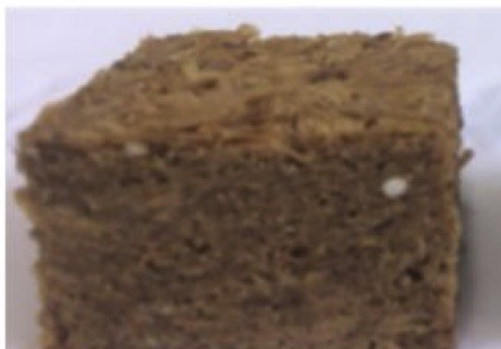
Εικόνα 40: Δοκίμιο μετά την ενυδάτωση
