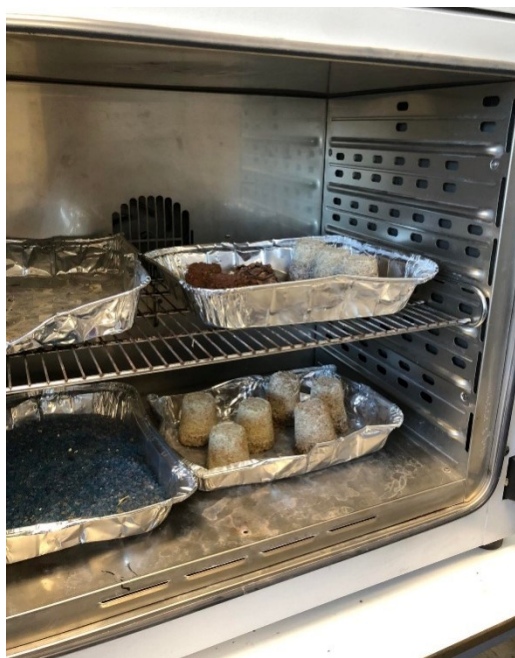
Εικόνα 62: Εισαγωγή δοκιμίων στον φούρνο
