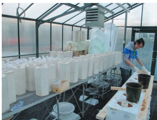
Εικόνα 23: Χύτευση βιοσύνθετων μικκυλίων ( https://www.mdpi.com/ )
