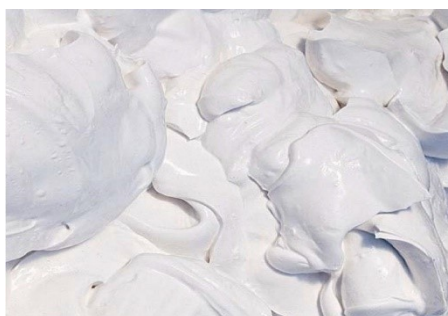
Εικόνα 49: Ασβεστοπολτός( https://betolit.gr/ )
