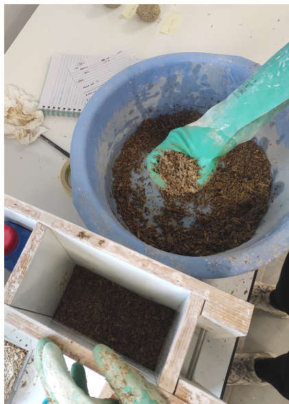
Εικόνα 114: Γέμισμα καλουπιού για τη δημιουργία τούβλου δοκιμής (προσωπικό αρχείο)
