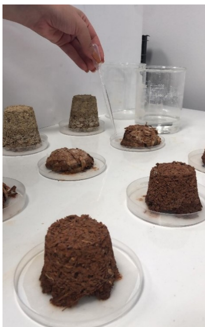
Εικόνα 61: Ενυδάτωση διηθητικού χαρτιού με διάλυμα αλάτων
