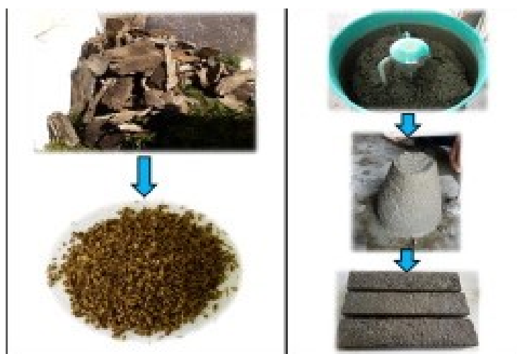
Εικόνα 15: Διαδικασία παραγωγής μονωτικών φελλού ( https://www.sciencedirect.com/ )
