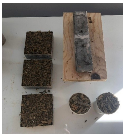
Εικόνα 101: Παραγωγή δοκιμών 50/50, πυκνότητας 0,699 \text{ g/cm}^3
