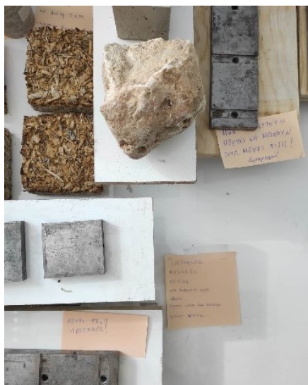
Εικόνα 105: Δοκίμια αναλογίας 50/50 και πυκνότητας 0,699 g/cm 3
