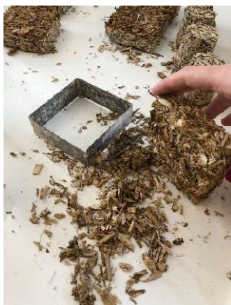
Εικόνα 93: Αστοχία δοκιμίου
