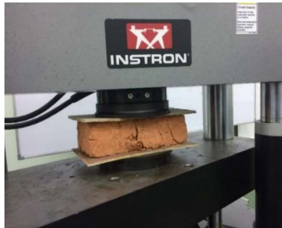
Εικόνα 28: Δοκιμή σε θλιπτικές δυνάμεις ( https://iopscience.iop.org/ )
