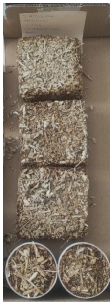
Εικόνα 102: Αφαίρεση καλουπιών
