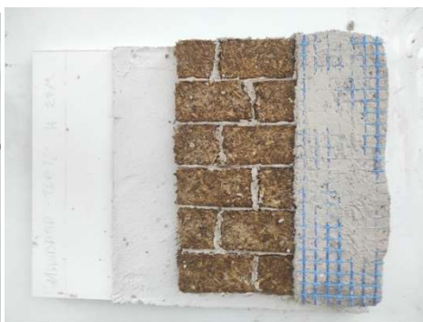
Εικόνα 120: Πρώτη στρώση επιχρίσματος με τοποθέτηση πλέγματος για αποφυγή ρηγμάτωσης του υλικού
