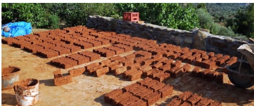
Εικόνα 30: Κατασκευή τούβλων από άχυρο ( https://www.cob.gr/ )
