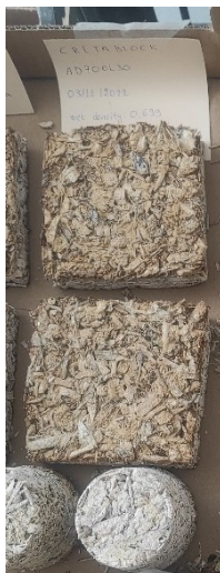
Εικόνα 100: Δοκίμια με πυκνότητα 0,699 \text{ g/cm}^3
