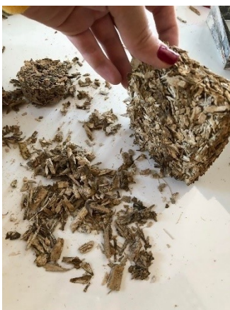
Εικόνα 94: Πλήρης αποκόλληση υλικού
