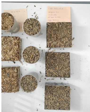
Εικόνα 103: Δοκίμια αναλογίας 70/30 και πυκνότητας 0,699 \text{ g/cm}^3
