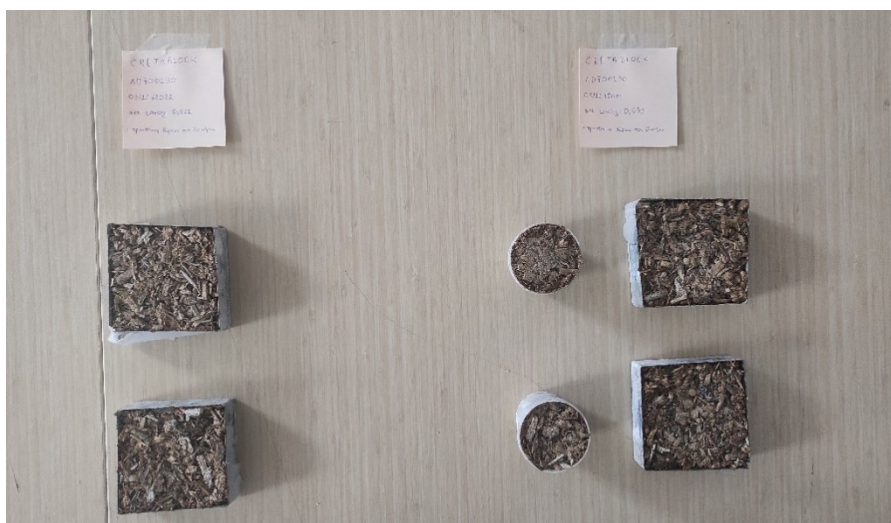
Εικόνα 98: Παραγωγή δοκιμίων με πυκνότητα 0,622 g/cm 3 και 0,699 g/cm 3
