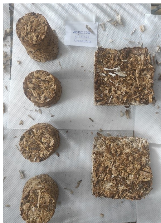
Εικόνα 97: Απώλεια τμημάτων κατά την αφαίρεση καλουπιών
