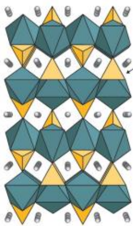
Εικόνα 3.4 Περιγραφή \text{LiFePO}_4 όπου το \text{PO}_4 είναι τετραεδρικό και το \text{FeO}_6 οκταεδρικό [17].
