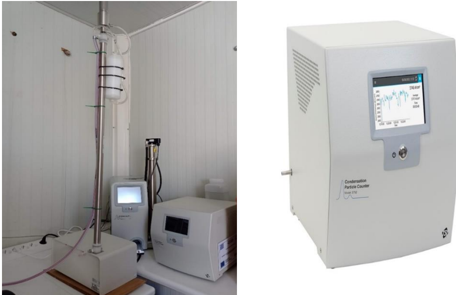
Εικόνα 3: Πειραματική διάταξη SMPS3938 (αριστερά) & Μετρητής σωματιδίων συμπύκνωσης CPC3750 (Anon., 2022)
