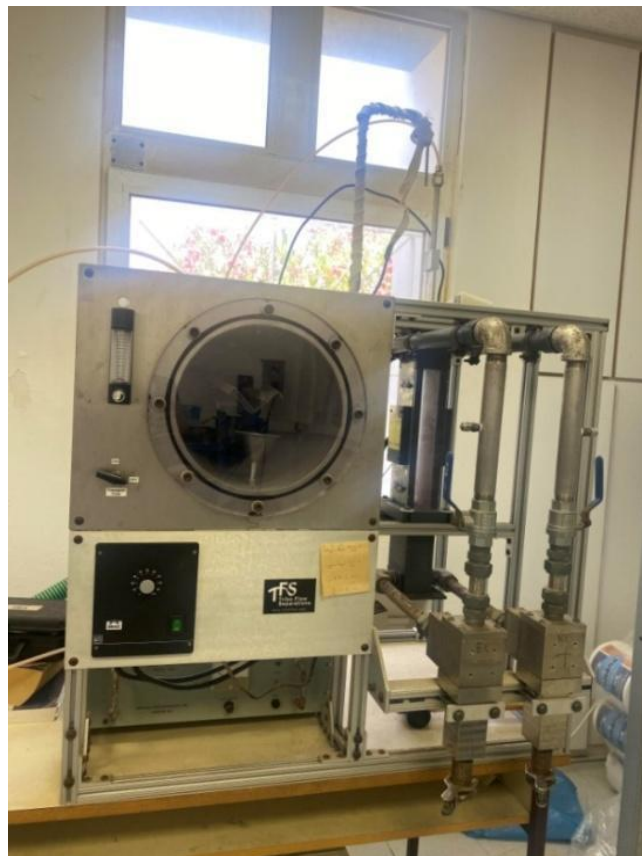
Εικόνα 2.6 Τριβοηλεκτροστατικός διαχωριστής εργαστηρίου.
