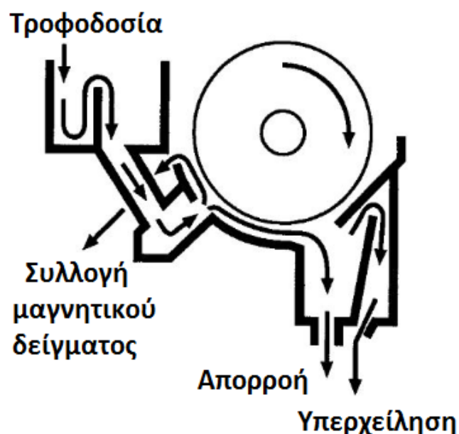
Εικόνα 1.13 Σχηματική αναπαράσταση υγρού μαγνητικού διαχωριστή [42].
