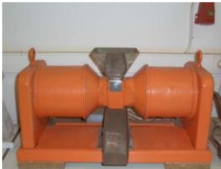
Εικόνα 2.5 Υγρός μαγνητικός διαχωριστής υψηλής κλίσης πεδίου του εργαστηρίου.
