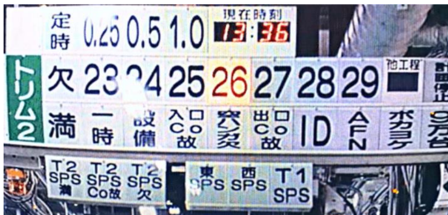
Σχήμα 4.2: Απεικόνιση συστήματος Andon (πίνακας) σε εργοστάσιο της Toyota στην Ιαπωνία [50]
