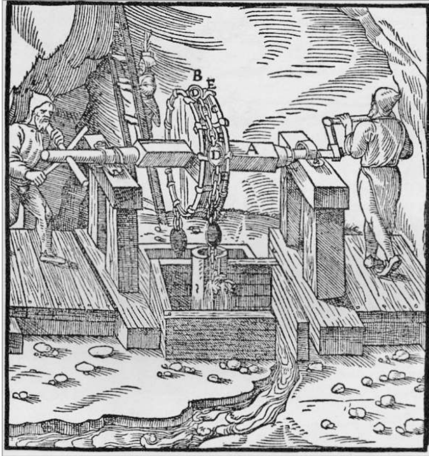
Εικόνα 5-5: Αντλία Pater noster (ή κουρελάκι και αλυσίδα), η οποία τροφοδοτείται από έναν μεγάλο υδροκίνητο τροχό. Η αλυσίδα εφαρμόζει με σφαίρες από δέρμα γεμισμένες με τρίχες αλόγου, που έχουν την ίδια διάμετρο με το εσωτερικό του σωλήνα 36
