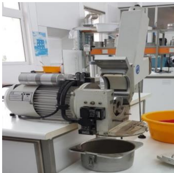
Εικόνα 3.3. Μαχαιρόμυλος άλεσης τύπου PULVERISETTE 15.
