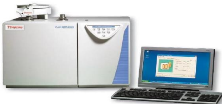
Εικόνα 3.4. Αυτόματος στοιχειακός αναλυτής Flash 2000 Series, της εταιρίας Thermo Fisher Scientific [6].
