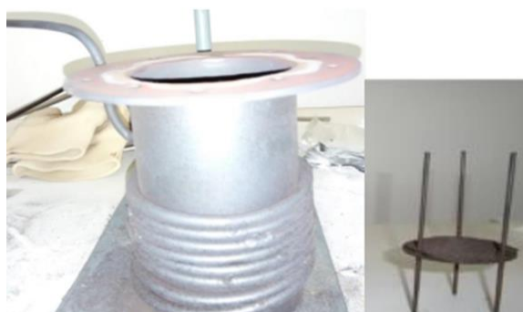
Εικόνα 3.6. Αντιδραστήρας από ανοξείδωτο χάλυβα και πυράντοχη σίτα.
