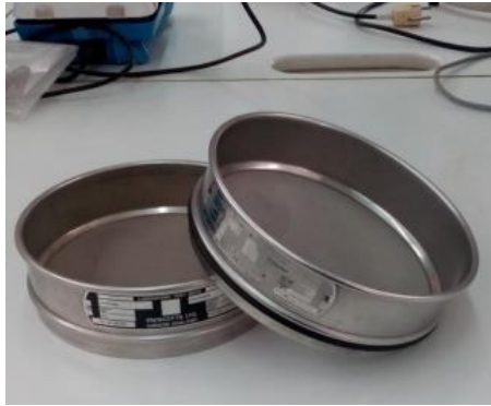
Εικόνα 3.2. Κόσκινα τύπου Analysette 3 Pro, FRITSCH.
