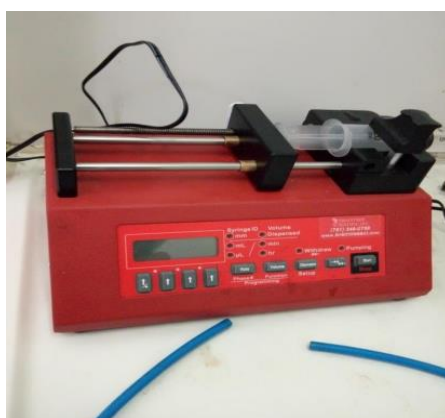
Εικόνα 3.9. Συσκευή παροχής ατμού με σωληνάκια σύνδεσης και σύριγγα με απιονισμένο νερό σε υγρή μορφή.
