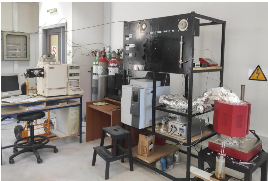
Εικόνα 3.4: Πειραματική διάταξη διεξαγωγής των πειραμάτων καταλυτικής συμπεριφοράς.
