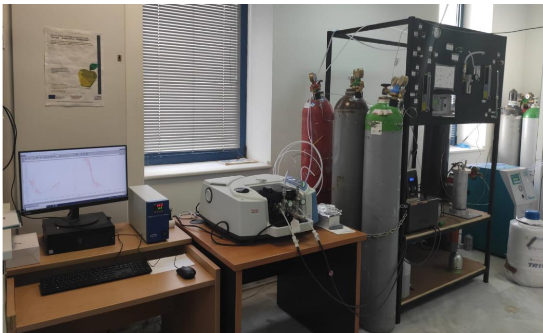
Εικόνα 3.5: Πειραματική διάταξη που χρησιμοποιήθηκε για τη διεξαγωγή των in-situ πειραμάτων DRIFTS.
