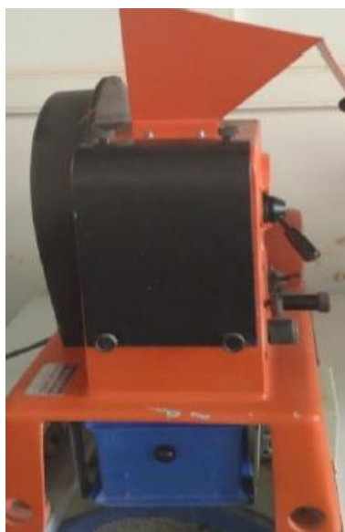
Εικόνα 7.1: Εργαστηριακός Σιαγονωτός σπαστήρας.
