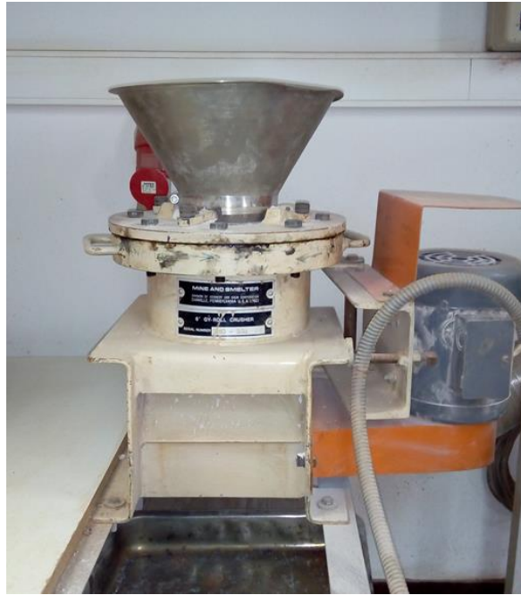
Εικόνα 7.2: Εργαστηριακός κωνικός σπαστήρας.
