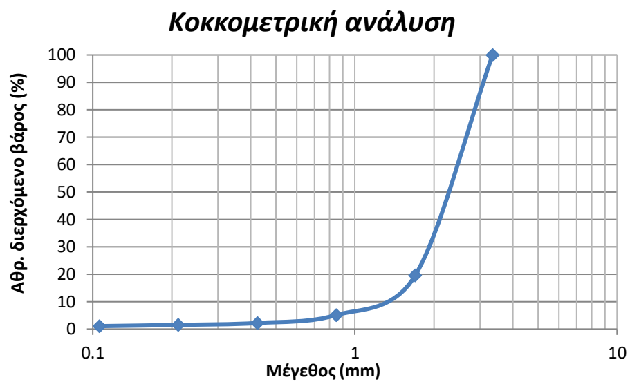
Διάγραμμα 6.2: Καμπύλη κοκκομετρικής ανάλυσης αρχικού δείγματος
