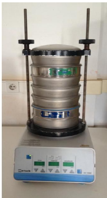
Εικόνα Error! Use the Home tab to apply 0 to the text that you want to appear here.5: Συσκευή Κοσκίνισης RETSCH VE 1000
