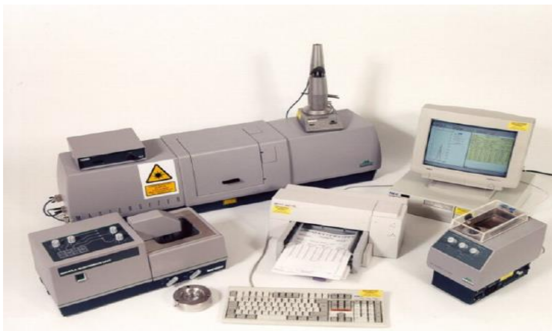
Εικόνα 7.6: Κοκκομετρικός αναλυτής Master sizer S τύπου Malvern (πηγή: Πετράκης, 2004).
