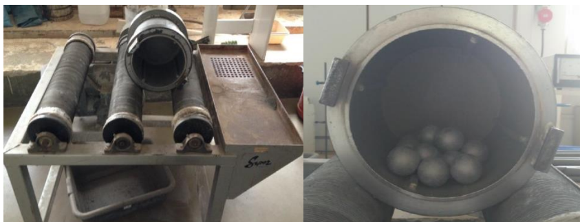
Εικόνα 7.3: Εργαστηριακός σφαιρόμυλος τύπου Sepor
