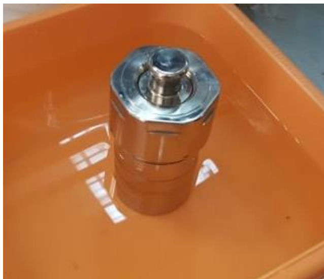
Εικόνα 20: Απεικόνιση εξωτερικού περιβλήματος του υδροθερμικού αντιδραστήρα τοποθετημένος σε δοχείο με νερό για την ταχύτερη επαναφορά του σε θερμοκρασία δωματίου ύστερα από την θέρμανσή του στον κλίβανο.
