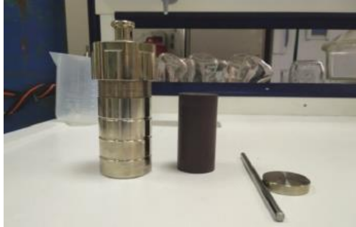
Εικόνα 17: Υδροθερμικός αντιδραστήρας από αριστερά το εξωτερικό περίβλημα, δεξιά το εσωτερικό δοχείο που τοποθετούνται τα αντιδραστήρια (Liliou , 2020)
