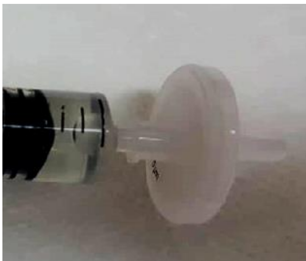
Εικόνα 22: Τοποθέτηση υγρού ύστερα από την υδροθερμική επεξεργασία σε ειδικό Falcon Tube έχοντας πρώτα διηθηθεί από φίλτρο διαμέτρου 45 \mu m. Το χαρακτηριστικό ανοιχτό μπλέ χρώμα οφείλεται στη μικρή συγκέντρωση χαλκού που εντοπίζεται κυρίως στους ημιαγωγούς του πάνελ.
