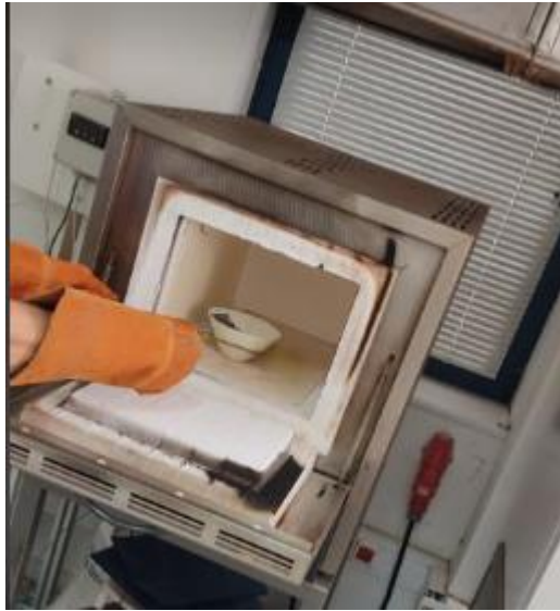
Εικόνα 11: Τοποθέτηση δείγματος στον κλίβανο με χρήση ειδικών θερμομονωτικών γαντιών.
