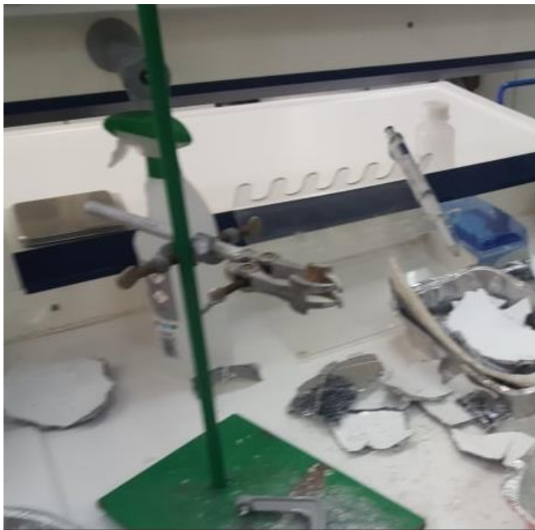
Εικόνα 8: Εργαστηριακή μέγγενη για την κοπή του Φ/Β πάνελ με τη χρήση ειδικού ψαλιδιού.
