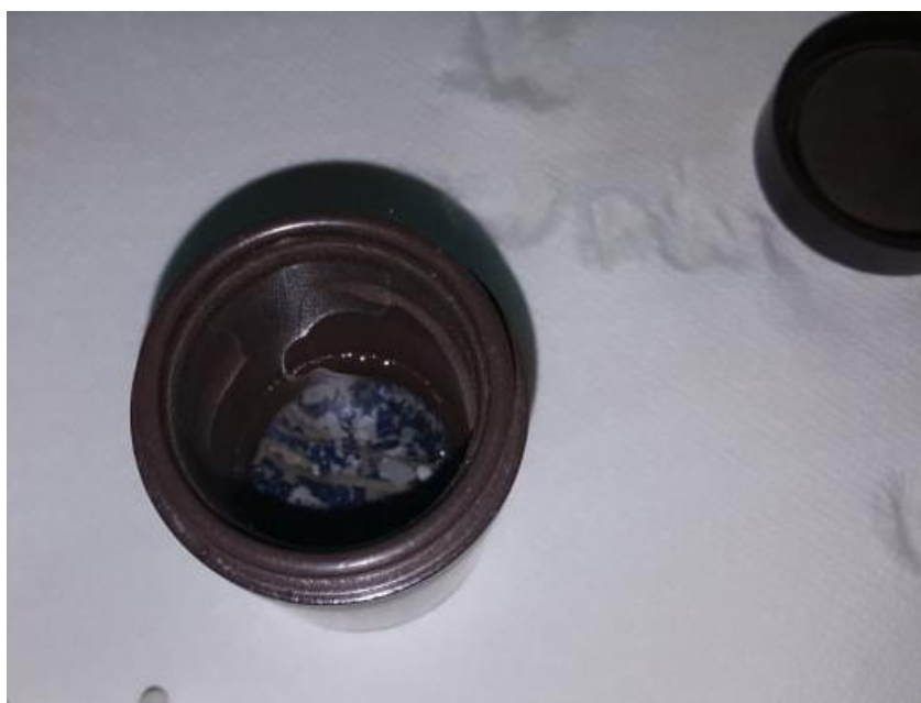
Εικόνα 21: Εσωτερικό δοχείο υδροθερμικού αντιδραστήρα με μη αλεσμένο υλικό στο εσωτερικό του.
