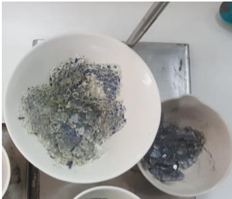
Εικόνα 12: Δοχεία πορσελάνης με πάνελ ύστερα από 20 min στους 600 °C, με εμφανή το διαχωρισμό του γυαλιού και του κελιού, αφού σε υψηλές θερμοκρασίες η κόλλα που τα συγκρατεί, καίγεται και αποσυντίθεται μαζί με το EVA.
