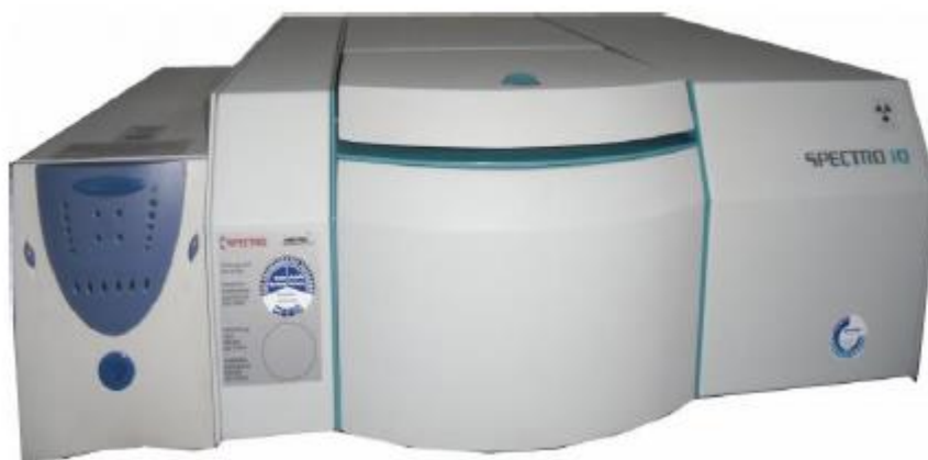
Εικόνα 16: Εργαστηριακό όργανο για τη φθορισμετρία : Spectro-X Lab Pro (Iatrou, 2020)
