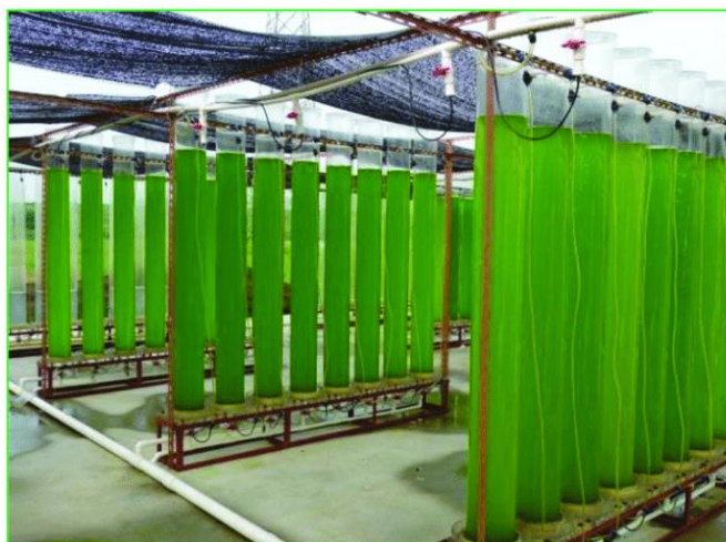
Εικόνα 1.7: Κάθετος αντιδραστήρας στήλης για την καλλιέργεια μικροφυκών
