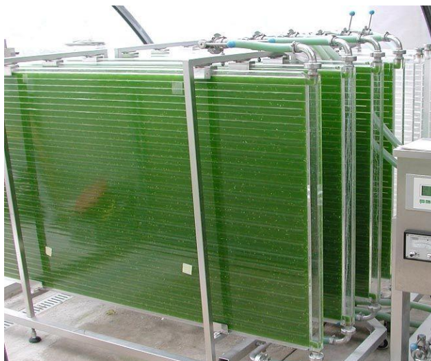
Εικόνα 1.5: Αντιδραστήρας επίπεδης πλάκας για την καλλιέργεια μικροφυκών
