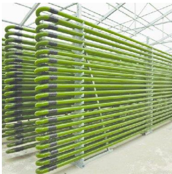
Εικόνα 1.6: Σωληνοειδής αντιδραστήρας για την καλλιέργεια μικροφυκών
